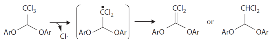
Figura 46. Proceso de deshalogenación por medio de fotodegradación.
