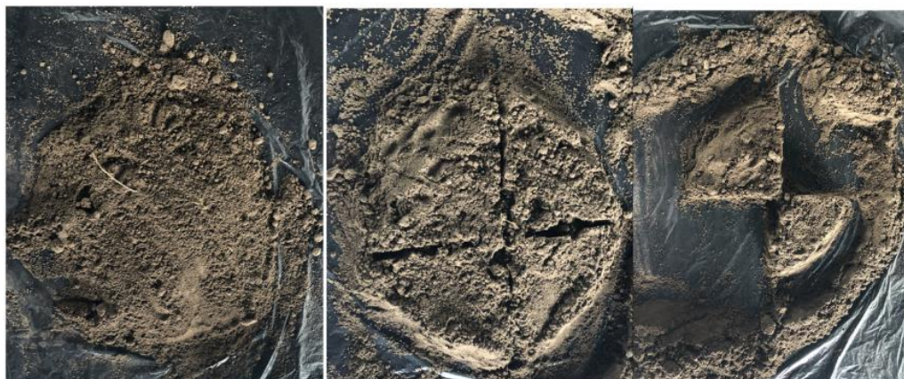
Figura 56. Muestra compuesta mediante sistema de cuarteo.
