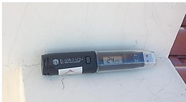
Figura 20. Equipo EL-USB LCD EasyLog RH/T & Dew Point colocado en la sombra del lugar de experimentación.
