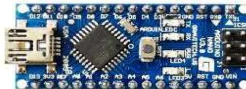
Figura 18. Arduino Nano, imagen física.
