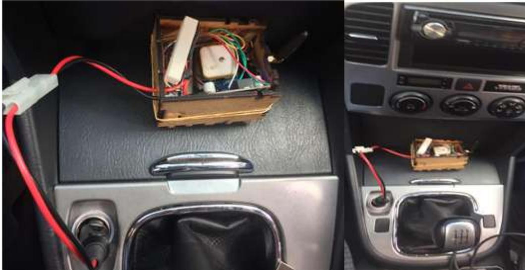
*Figura 32.* Prototipo conectado a fuente de energía del vehículo 12 VCD.
