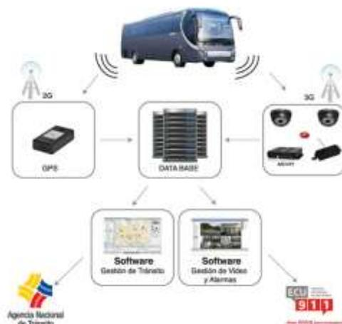
*Figura 1.* Transporte Seguro. Diagrama esquemático funcionamiento de Ecu 911, control de transporte.
