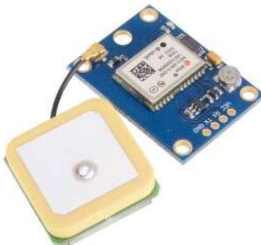
*Figura 16.* Módulo Neo6MV2 control de GPS, imágenes físicas
