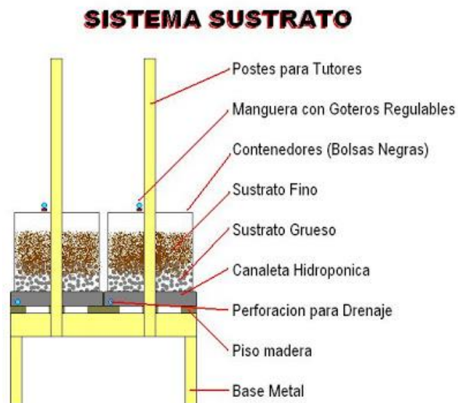
Figura 57. Estructura de tanques de Riego Hidropónico
