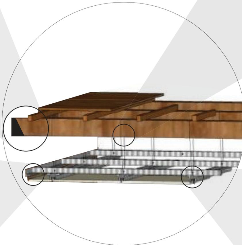
DETALLE 2: INSTALACIÓN DE CIELO FALSO DE PLACA DE GYPSUM
