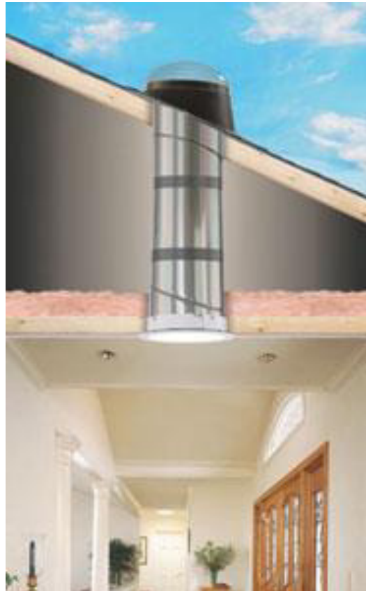
Figura 22. Túnel Solar en cubierta inclinada.
