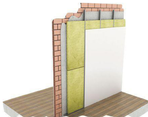
Figura 20. Detalle de Colocación de Planchas de Poliuretano Tomado de: (Manuj, s.f.)
