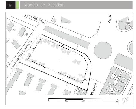
Creando un retiro de 5 metros en el perímetro del predio hacia el interior como mínimo, integrando una cubierta verde y creando un sistema de arborización que combatan con el ruido de la zona. Manteniendo los dB necesarios al interior del proyecto.
