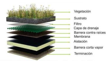
Figura 90. Cubierta Verde en Detalle
