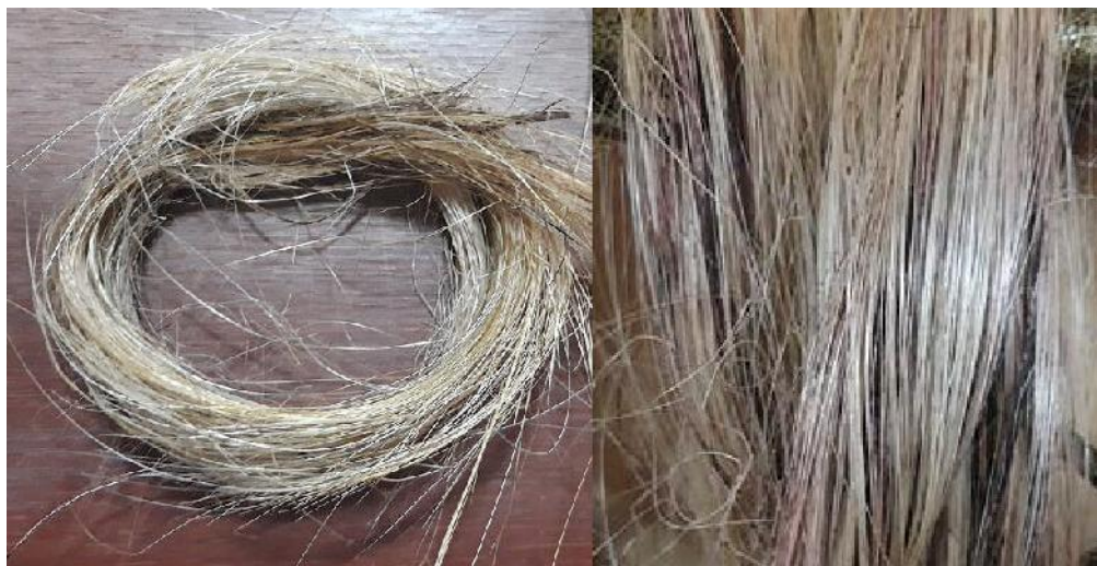
Figura 93. Comparación: Izquierda, con descruce; Derecha, sin descruce.
