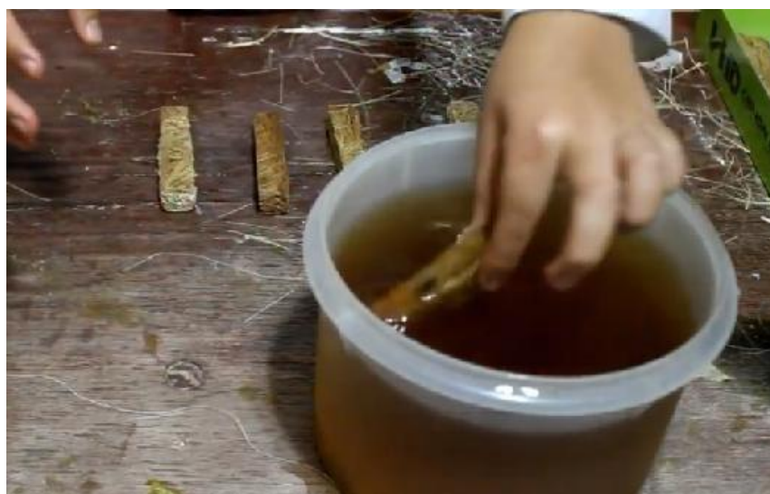
Figura 157. Pieza aplicando impermeabilizante.
