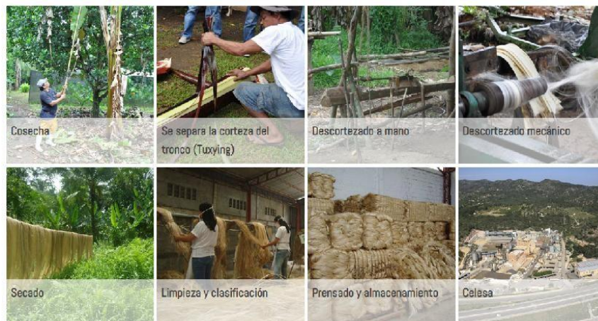
Figura 14. Proceso de extracción del Abacá.
