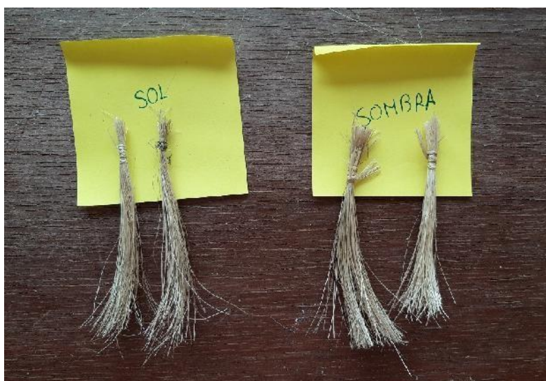
Figura 92. Comparación de secado a luz y a sombra después de descruce.
