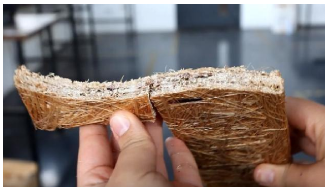
Figura 142. Corte con caladora de precisión, resultados.
