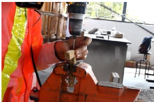
Figura 149. Perforado con taladro de mano.
