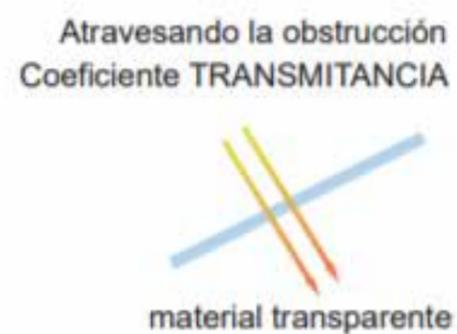
Figura 79. Comportamiento de los Materiales con los rayos ultravioletas
