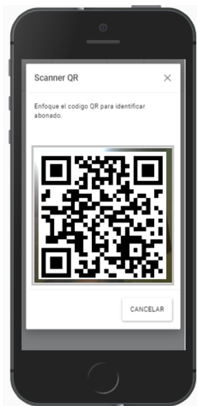
Figura 17. Modo de funcionamiento de Instascan para identificar abonados.
