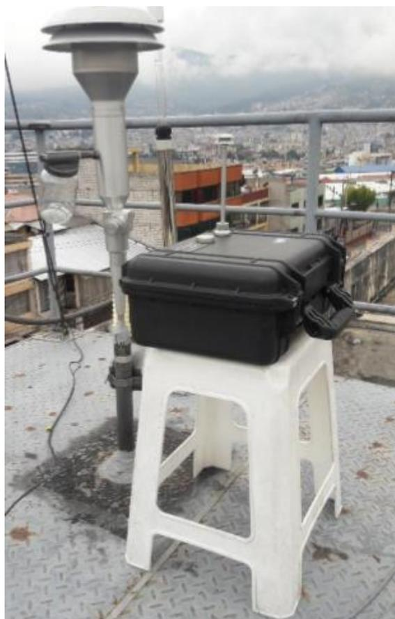
**Anexo 11.** Medición de la velocidad y dirección del viento con el equipo anemómetro TSI Airflow TA 430.
