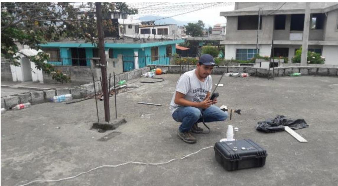
**Anexo 3.** Instalación del equipo Microdust Pro en la estación “Sangolquí industrial”.
