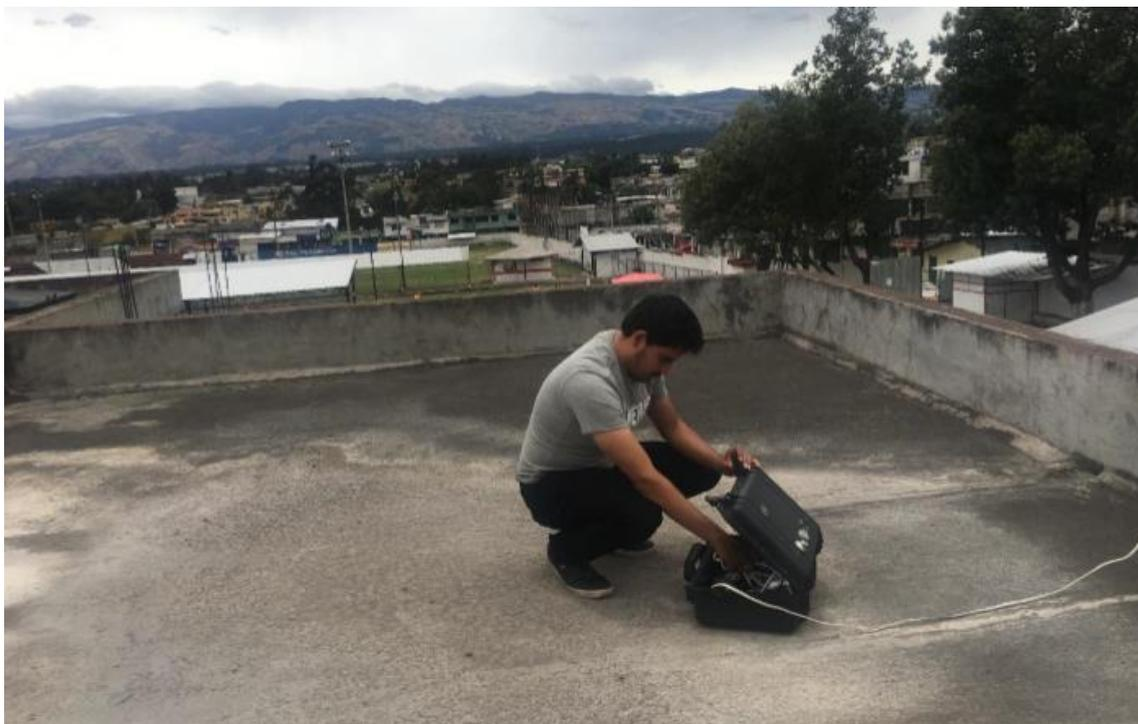
**Anexo 5.** Instalación del equipo Microdust Pro en la estación “Cotogchoa”.
