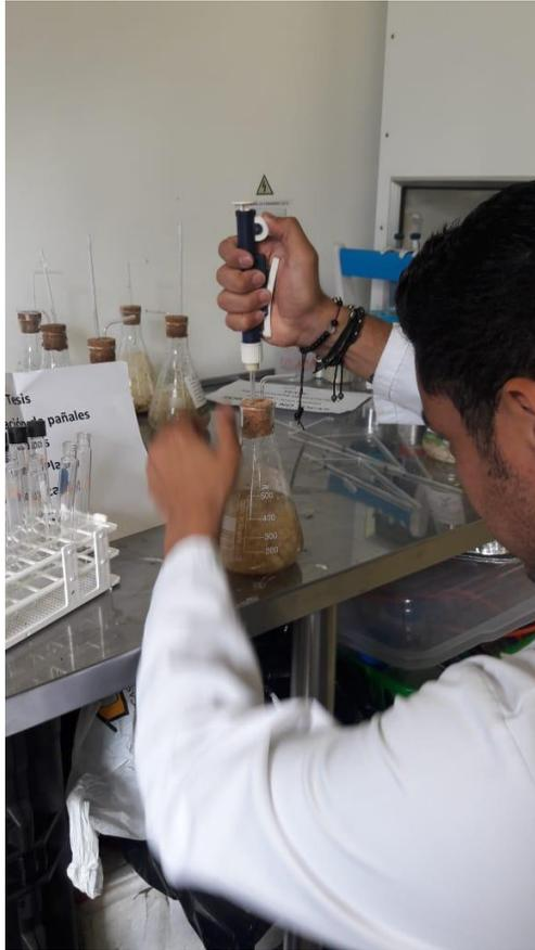
**Anexo 12. Extracción del líquido de los ensayos para determinar la glucosa producida.**
