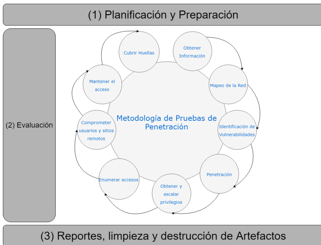
Figura. 3. Fases para la aplicación de la Metodología Pruebas de Penetración. Adaptado de ISSAF, 2008, p. 147
