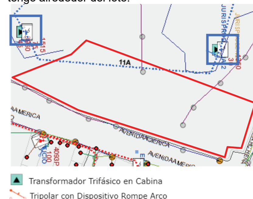
Figura 1 y 2. Ubicación conexión de red eléctrica. Tomado de la EEQ.
