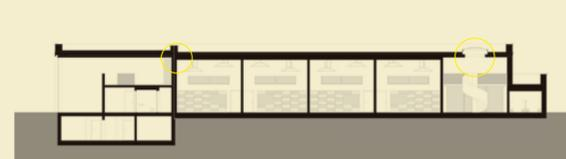
Se utiliza estructura de hormigón, el edificio se eleva ligeramente sobre la cota del terreno y se adosa al talud.
