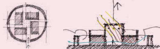
El interior de la guardería, se encuentra climatizado por paneles radiantes en suelo y con una instalación de ventilación que controla la humedad y la renovación del aire.
