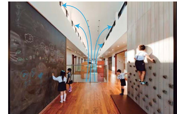
Figura 111. Ventilación Dobles Alturas.
