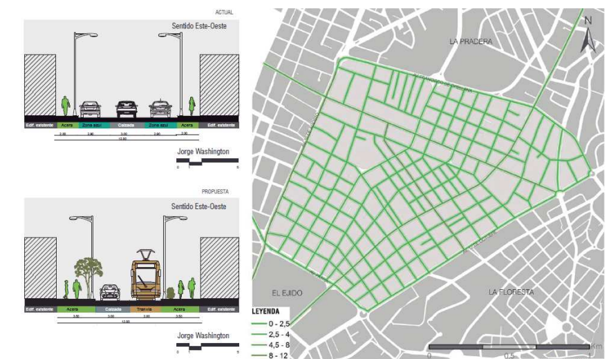
Figura 84. Mapeo de intervención en anchos de aceras.
