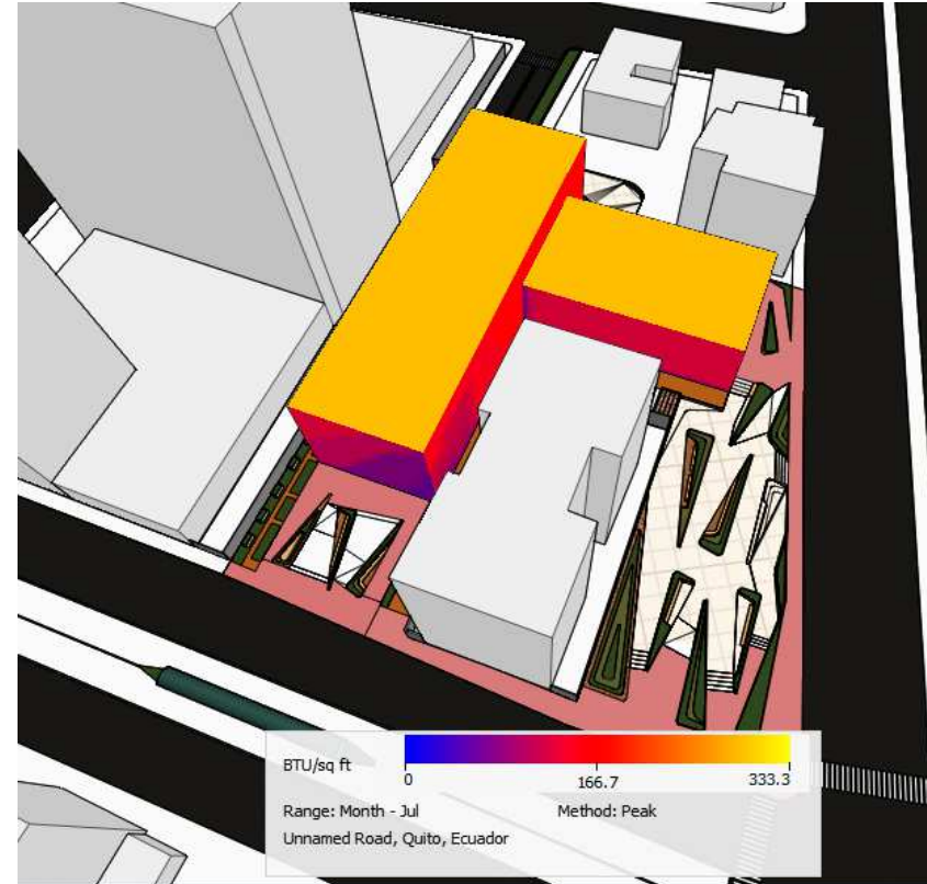
Figura 153. Análisis de radiación de fachada frontal.
