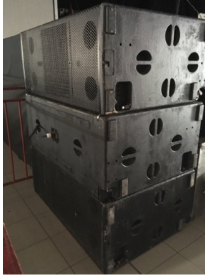
Figura 20. Arreglo gradiente con 3 subgraves.
