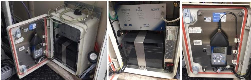
*Figura 6.* Equipo de medición de ruido SV210 en la estación Centro
