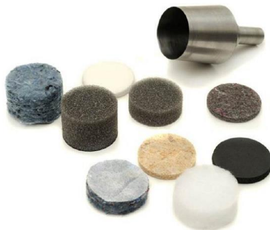
Figura 19. Cortador de muestras con algunos materiales cortados. Tomado de Spectronics, 2016.
