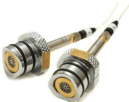
Figura 15. Micrófonos para las mediciones (ACUPRO)
