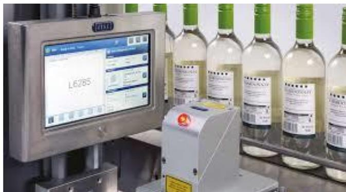
*Figura 8.* Codificadora Láser Modelo CSL60
