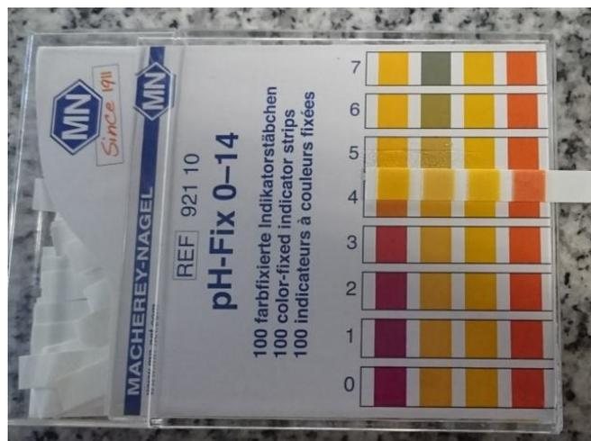
Figura 25. Determinación de pH en aceite esencial.
