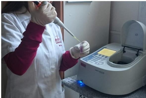
Figura 28. Colocación de la muestra de aceite esencial en la cubeta con DPPH.
