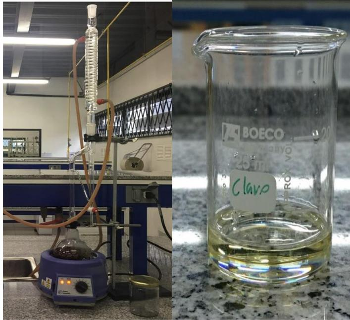
Figura 14. Obtención del Aceite Esencial de Clavo de Olor (*Syzygium aromaticum*) por medio del método hidrodestilación.
