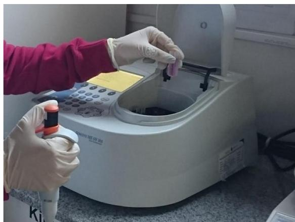
Figura 29. Colocación de la cubeta en el Espectrofotómetro UV-Visible THERMO SCIENTIFIC.
