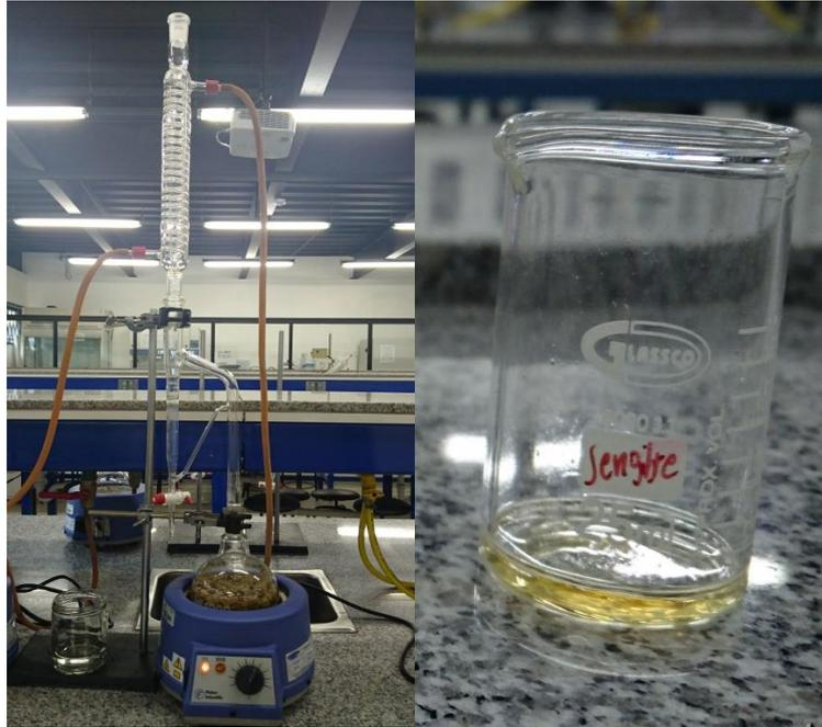
Figura 12. Obtención del Aceite Esencial de Jengibre (*Zingiber officinale*) por medio del método hidrodestilación
