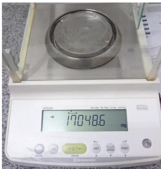
Figura 26. Pesaje del vidrio de reloj con aceite esencial.
