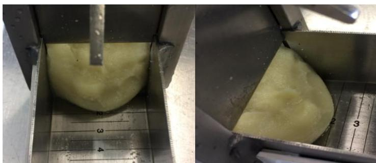
Figura 10. Medición del desplazamiento en consistometro de Bostwick.
