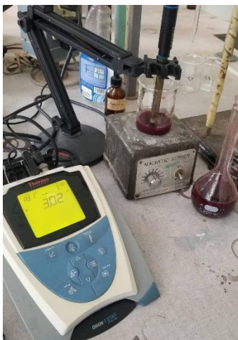
Figura 3. Proceso de medición de pH y acidez titulable del fruto de mortiño, 2018.
