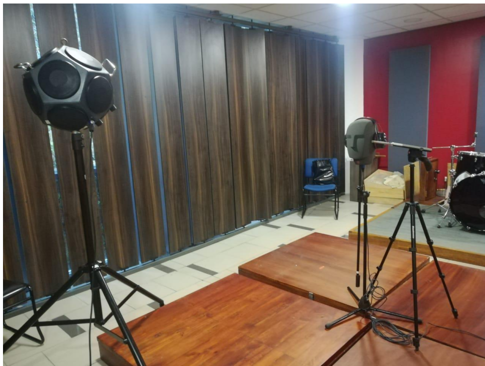
Figura 12. Medición con protector auditivo.
