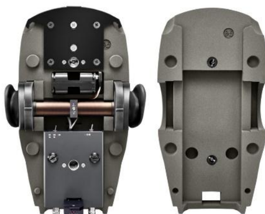
Figura 5. Corte de un Dummy Head.
