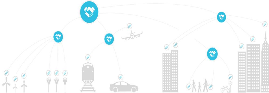
Figura 27. Arquitectura DSA con distintos nodos que se suscriben a sus brokers respectivos para la agregación de datos.
