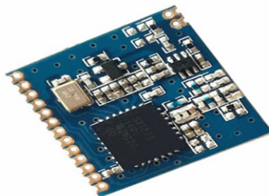
Figura 37. Módulo LoRa SX1278 del fabricante Semtech con una frecuencia de operación de 433 Mhz.
