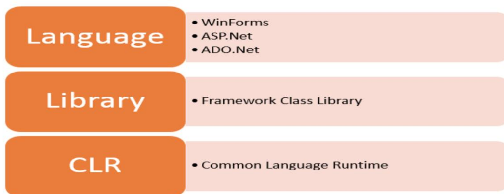
Figura 28. Diagrama de la arquitectura del framework de .NET.
