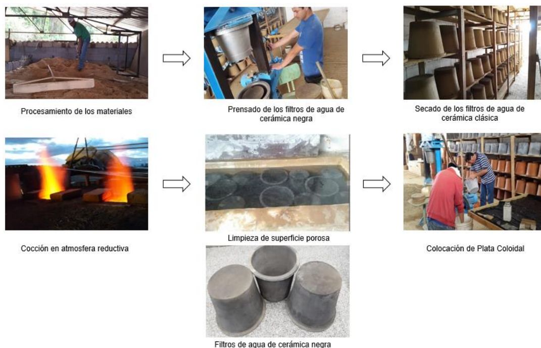
Figura 14. Proceso de producción de los filtros de agua de cerámica negra.
