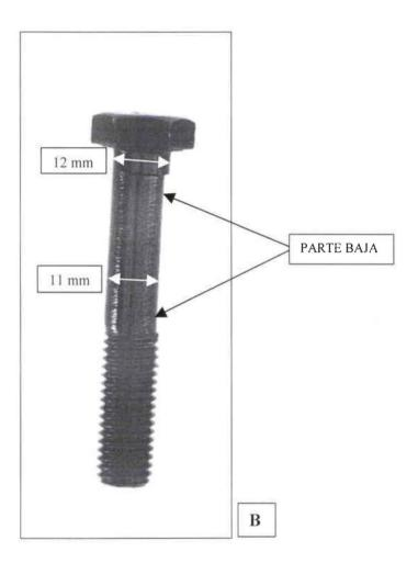
En el gráfico B se identifica claramente en lo que consiste el trabajo de torno, el punto que se ve en la otra fotografía, se localiza paralela a la parte más baja del perno. El perno sufrirá un corte excéntrico en la mayor parte del centro, dándole un diámetro de 11 mm contra los 12 mm originales que trae la mayor parte de vehículos de suspensión MACPHERSON. El diámetro reducido hará que el neumático oscile su inclinación.
