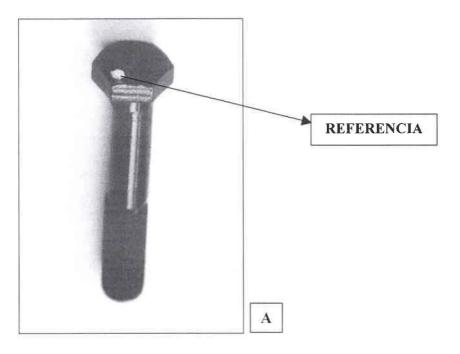
En gráfico A se puede observar el perno trabajado con el punto de referencia que se utilizará para ubicar el giro del perno para que los técnicos corrijan el
