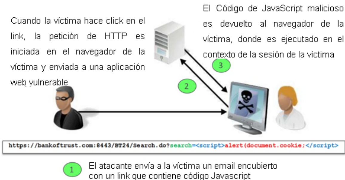
Figura 18. Cross Site Script esquema de ataque. Adaptado de (Codecamp Romania, 2012).
