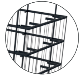
Subestructura de perfiles de acero para los paneles de las celosías de madera
