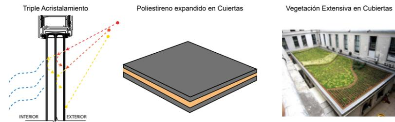
Figura 76. Elementos de control de radiación.
