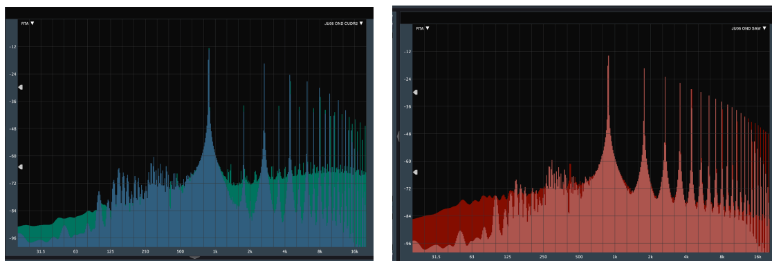
Figura 27. Espectro de frecuencias Mopho SE vs JU-06, onda cuadrada y diente de sierra
