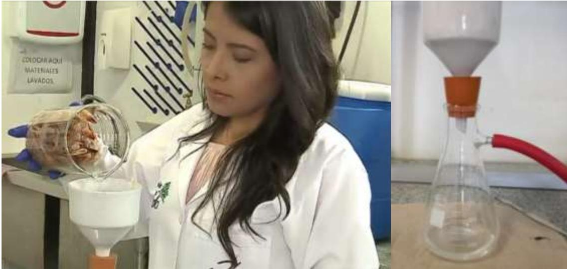
9. Filtración de la muestra después de 24 horas.
