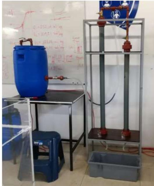
*Figura 15.* Columnas de adsorción.
