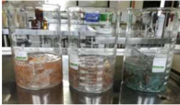
Figura 14. Pruebas batch con el material adsorbente y el adsorbato.
