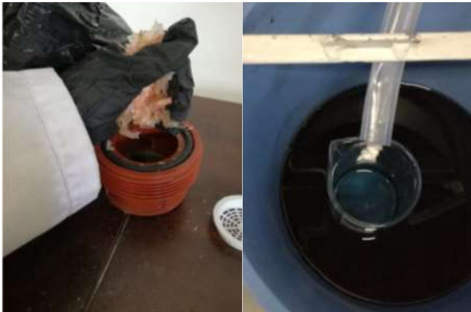
15. Colocación del material adsorbente en las columnas de adsorción y obtención de las muestras en tiempos determinados.
