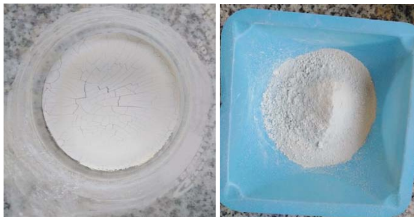
Figura 10. Obtención de TiO 2 dopado con puntos de carbono
