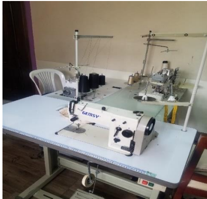
Figura 80. Módulo 1 Máquinas (Recubridora Collaretera, Recta y Overlock 4 hilos) Tomado de (Mia, 2018)
