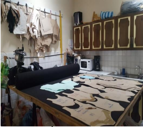
Figura 17. Área de corte En la siguiente imagen se observa el área de corte, donde empieza el proceso con el corte de los moldes en la tela. Tomado de (Mia, 2018)
