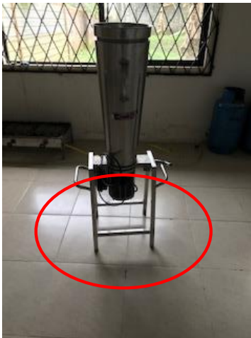
Figura 39. Falta de señalización para la ubicación de la maquinaria
