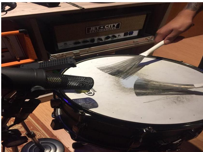
Figura 11: Shure sm7b y Se electronics VR1 a puntando a la mitad de la caja
