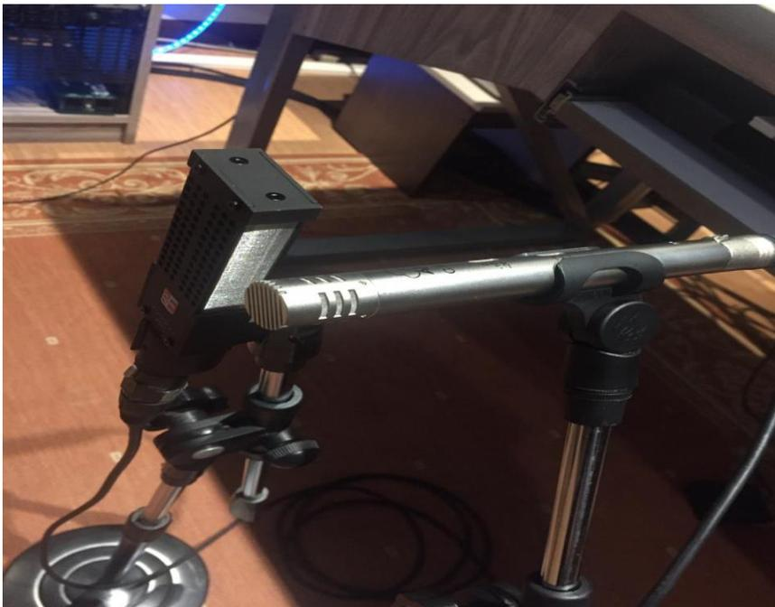
Figura 3: Micrófonos: AKG 451 y Se electronics VR1 (Ribbon)
