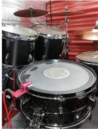
Figura 27. *Trigger* montado en *snare*
