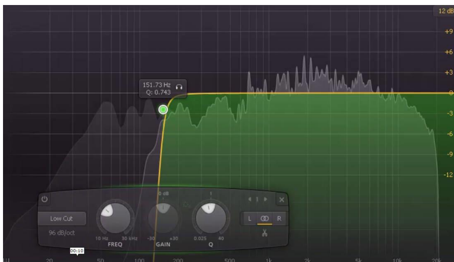
Figura 109. High pass en los 100 Hz aproximadamente. Desaparecen todos los graves profundos y la mezcla se siente débil.
