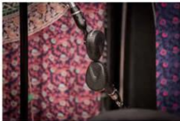
Figura 5. Micrófonos de cinta en configuración Blumlein Array . Tomado de Recording Metal with Eyal Levi .
