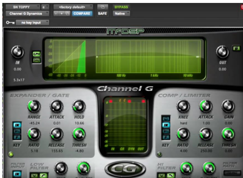
Figura 31. Configuración de gate para caja ( top mic ) que utiliza Taylor Larson en sus mezclas. Tomado de Nail The Mix junto a Taylor Larson y Jason Richardson
