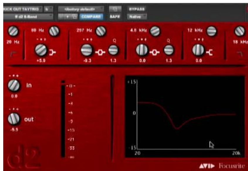
Figura 39. Ejemplo del uso de ecualizador en un trigger del kick . La atenuación después de los graves es más notoria esta vez. Tomado de Nail The Mix junto a Taylor Larson y Jason Richardson
