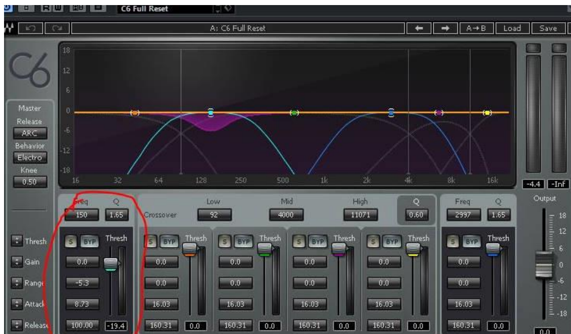
Figura 75. Ejemplo de compresión multibanda aplicada a guitarras para controlar palm muting . Acle Kahney recomienda usar el modo de release manual y comportamiento en opto . Tomado de Processing and Mixing Guitars de Acle Kahney.
