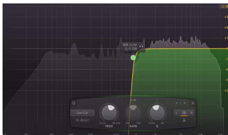
Figura 104. High pass cerca de los 1000 Hz. La voz y guitarras pierden su cuerpo, se escucha claramente el ataque del bombo y caja. Pero en los 3000 Hz ese ataque se va y destacan mucho los agudos de los platos.
