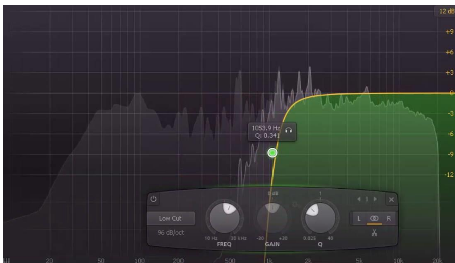
Figura 116. High pass en los medios. Se siente mucha filtración, especialmente en la voz. En los 5000 Hz la caja todavía retiene un poco de ataque. Cerca de los 9000 Hz destaca el ataque de los toms sin perderse.
