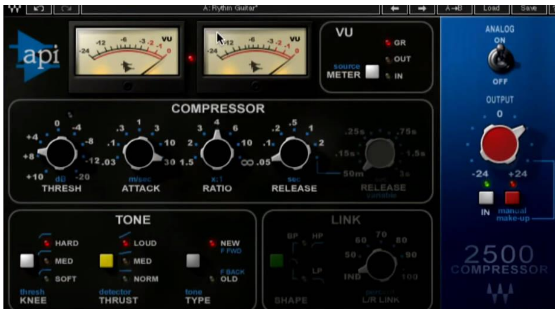
Figura 78. Preset de Taylor Larson de compresión para guitarras agresivas con el compresor API 2500. Tomado de Nail The Mix junto a Taylor Larson y Jason Richardson.
