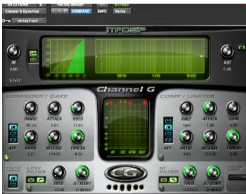
Figura 32. Configuración de gate para caja ( bottom mic ) que utiliza Taylor Larson en sus mezclas. Tomado de Nail The Mix junto a Taylor Larson y Jason Richardson
