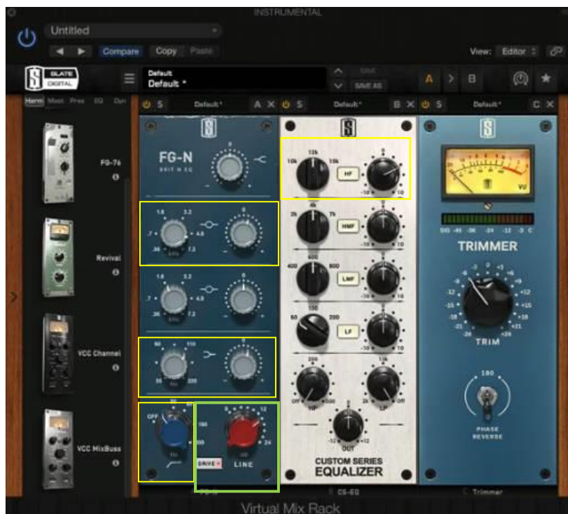
Figura 28. Ecuador FG-N del VMR basado en un Neve . Amplificando frecuencias cerca de los 5 kHz y los 110 Hz, con una leve activación del high pass filter (recuadros con borde amarillo) y agregando más drive con el control de Drive encendido en el Line (recuadros con borde verde). Ecuador Custom Series dando un boost en los 12 kHz (recuadros con borde amarillo) y finalmente un trimmer para regular la ganancia. Adaptado de Nail the Mix junto a Adam "Nolly" Getgood de Periphery .
