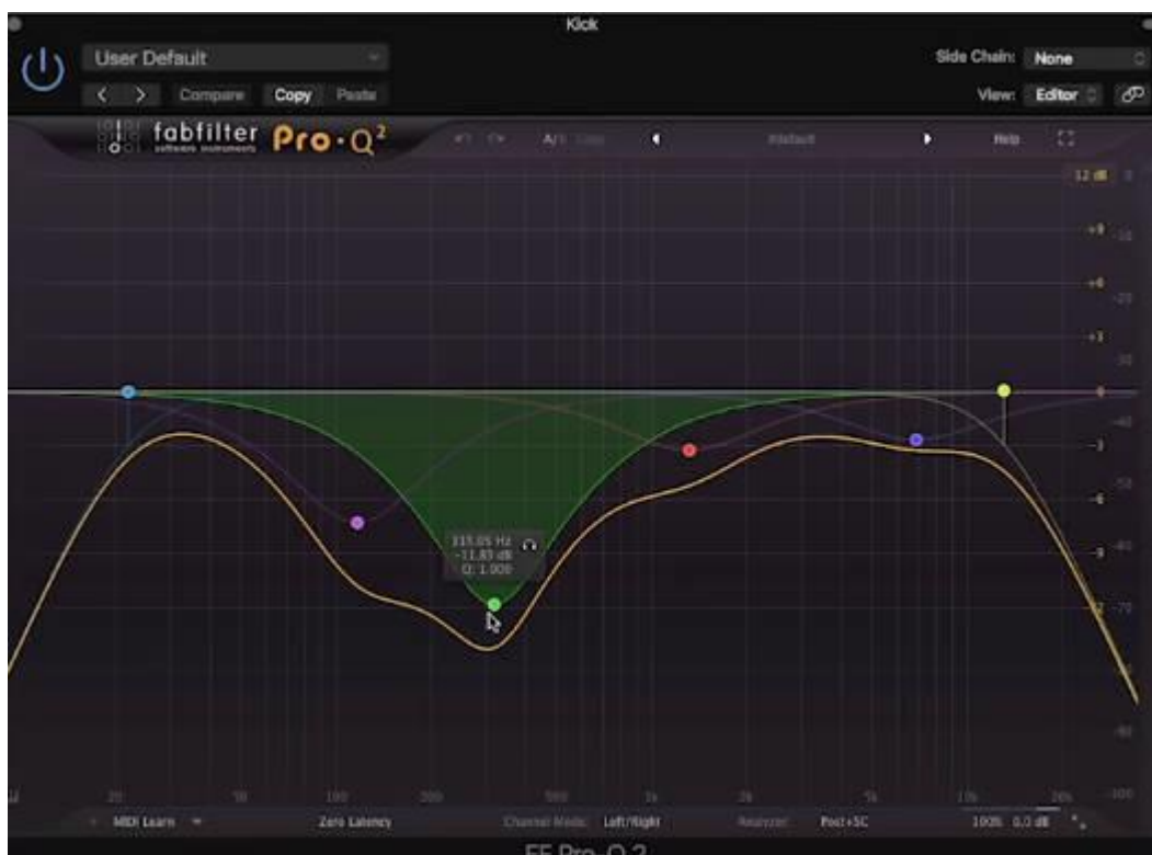
Figura 48. Ecualización sustractiva aplicada a un bombo de batería por Adam Getgood. Tomado de Adam "Nolly" Getgood Mixing Masterclass en Youtube.
