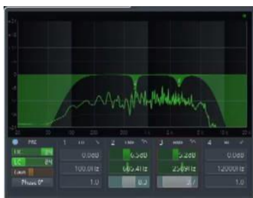
Figura 79. Ecualizador stock de Cubase para limpiar guitarras lead . Como se ve en el analizador de espectro, se filtran frecuencias que simplemente no se están usando en el instrumento, así como otras que sean molestas con bandas delgadas. Tomado de Nail The Mix junto a John Browne de Monuments .
