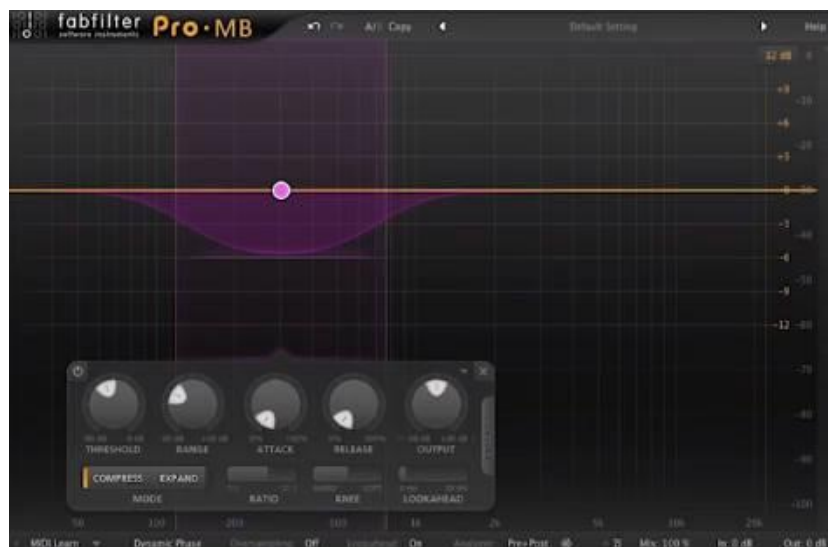
Figura 96. Compresión multibanda aplicada a una voz suave para controlar la cara de medios graves. Tomado de Adam "Nolly" Getgood Mixing Masterclass en Youtube.
