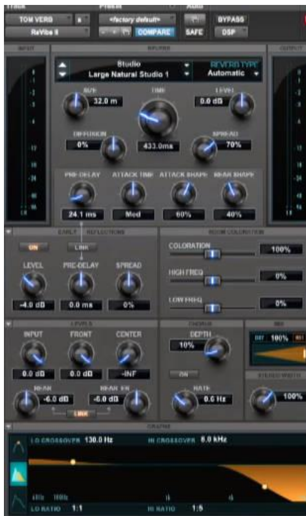
Figura 44. Reverb de Larson que no aporta graves para los toms lo que haría que arruinen la mezcla. Tomado de Nail The Mix junto a Taylor Larson y Jason Richardson.
