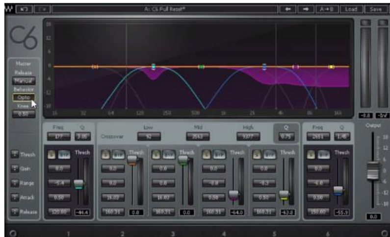
Figura 55. Waves C4. Se usará este compresor en modo manual y opto. Después un ataque muy rápido y release entre 100-200 milisegundos en cada banda. Tomado de Mixing Bass de Aclé Kahney.
