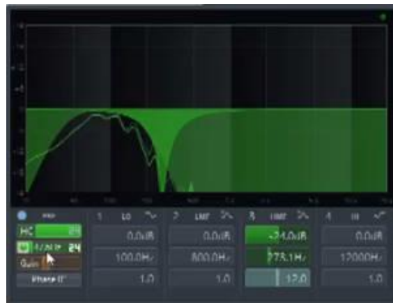
Figura 64. Filtrado y EQ de la señal para graves. Como se puede observar en el análisis de espectro se filtra la señal para quedarse solo con los graves. Tomado de Nail The Mix junto a John Browne de Monuments .
