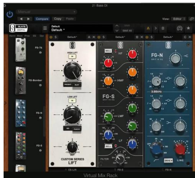
Figura 61. Dando forma al sonido de bajo y agregando agudos con VMR de Slate Digital . Tomado de Nail the Mix junto a Adam “Nolly” Getgood de Periphery .
