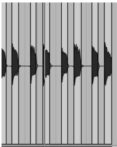
Figura 143. Muting de los finales de ondas de sonido para hacer el sonido más apretado y remover resonancia indeseada en las guitarras. Los audios en mute tienen un color más blanco.
