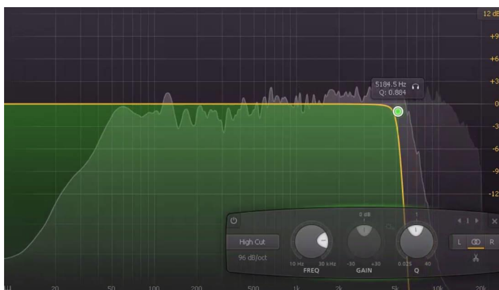
Figura 106. Low pass arriba de los 5000 Hz. El sizzling de los platos prácticamente desaparece y se empiezan a perder las consonantes de la voz.
