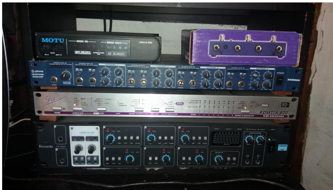
Figura 141. Rack de la interfaz y convertidores Apogee.
