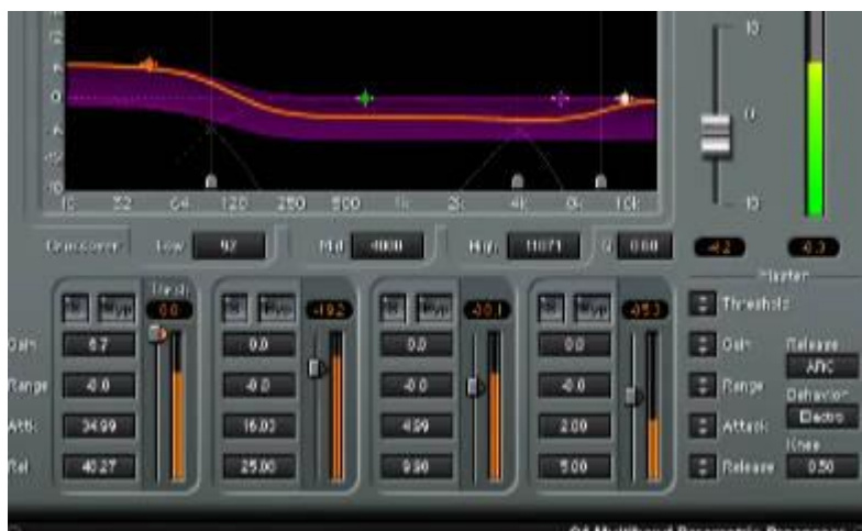
Figura 72. Compresión multibanda aplicada a la pista de bajo grave removiendo el umbral para que se quede estática, mientras que en el resto de las bandas se mueve atenuando las frecuencias. Tomado de Nail The Mix junto a Taylor Larson y Jason Richardson.
