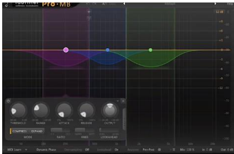
Figura 89. Compresión multibanda aplicada a submix de voces con tres bandas, controlando graves, medios y agudos. Tomado de Adam "Nolly" Getgood Mixing Masterclass en Youtube.
