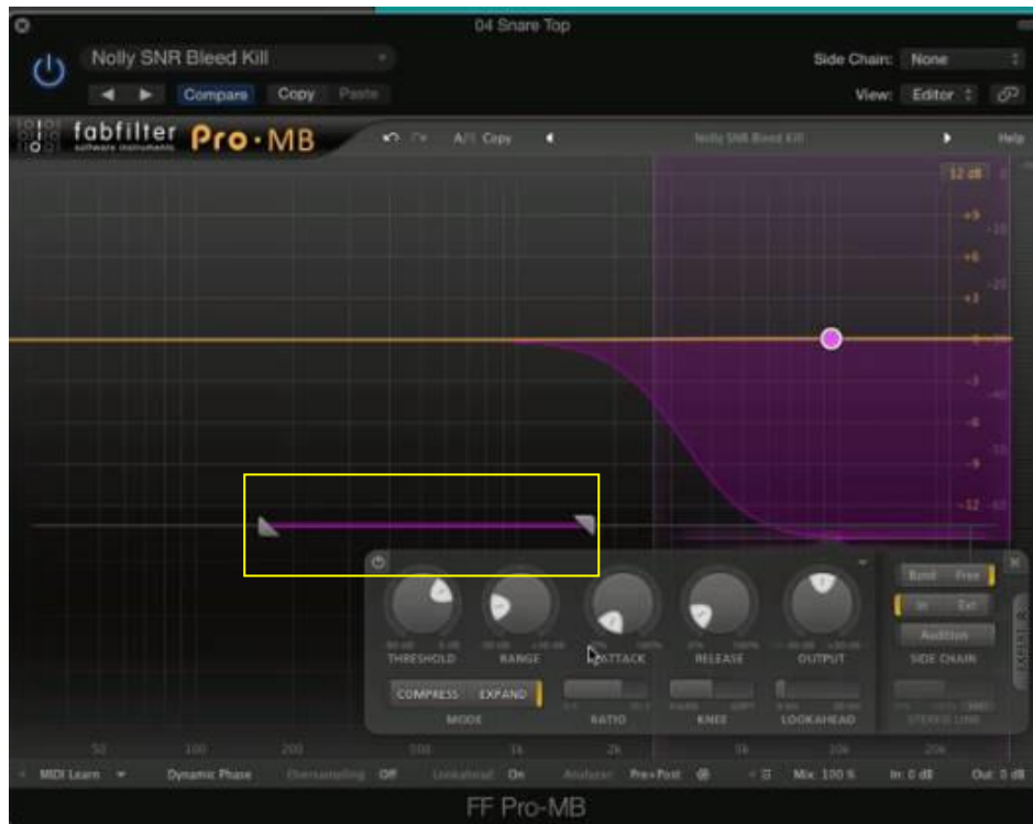
Figura 30. Compresor multibanda de Fabfilter configurado como gate de agudos para evitar bleed . Marcado en el cuadro amarillo se observa la configuración de la “mira” del gate en un rango aproximado de 180-1500 Hz. Tomado de Nail the Mix junto a Adam “Nolly” Getgood de Periphery .
