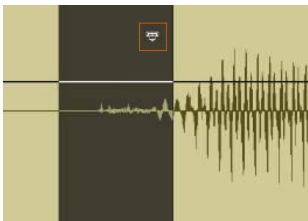
Figura 86. Selección de consonante y activación de la herramienta trim marcada en el cuadro naranja. Adaptado de Mixing Heavy Metal and Rock con Kenny Gioa.
