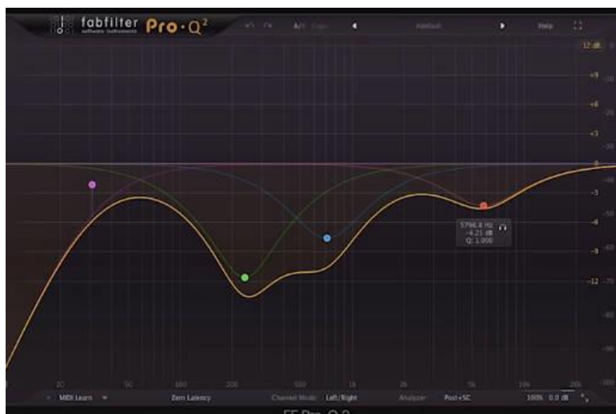
Figura 51. Ecuación aplicada a tom de rack. Tomado de Adam “Nolly” Getgood Mixing Masterclass en Youtube.
