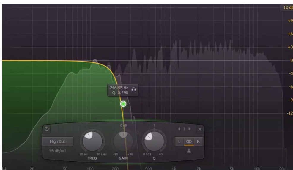
Figura 108. Low pass en medios graves. Prácticamente solo se escucha la información grave, pero todavía la información es inteligible, pero en los 300 se pierde la voz y cualquier detalle que quedaba de las guitarras. Solo se escuchan resonancias graves y los graves de la caja resaltan, esta caja tiene mucho ataque.
