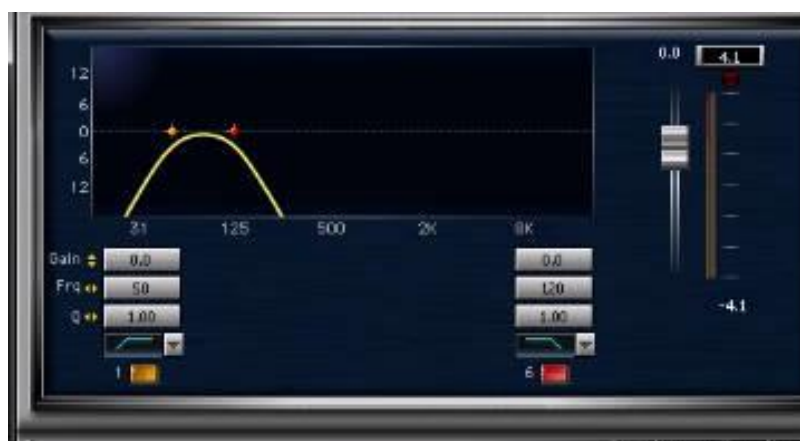
Figura 67. Filtrado aplicado a una pista de bajo grave. Tomado de Modern Metal Bass Tone Tutorial de Chernobyl Studio en Youtube.
