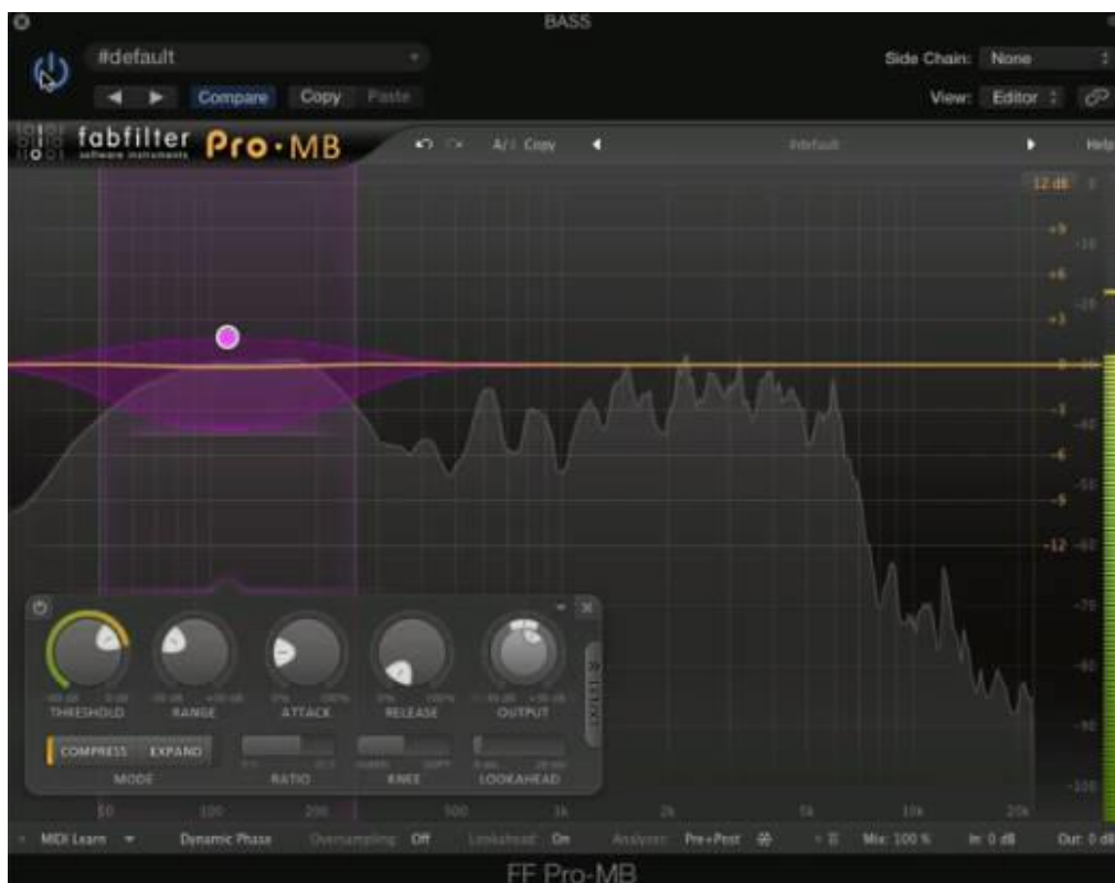
Figura 62. Truco de compresión multibanda para estabilizar las frecuencias fundamentales graves en un bajo, al comprimir y dar un boost al mismo tiempo para no perder nivel. Tomado de Nail the Mix junto a Adam “Nolly” Getgood de Periphery .
