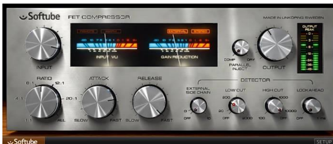
Figura 45. Softube FET Compressor con ratio elevado, ataque y release muy rápidos para aplastar el sonido para compresión paralela. Tomado de Mixing Metal Drums: Parallel Compression del canal de Youtube URM Academy.
