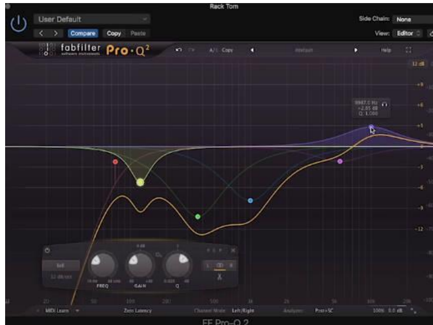
Figura 50. Ecuación aplicada a tom de piso. Tomado de Adam “Nolly” Getgood Mixing Masterclass en Youtube.
