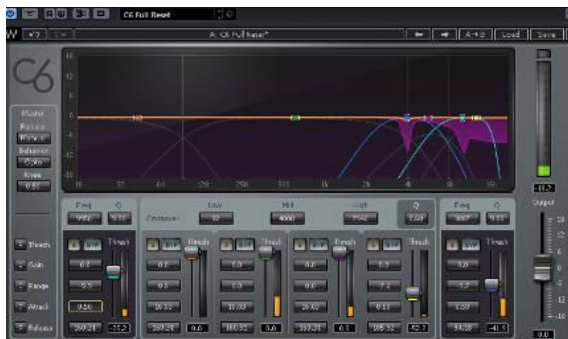
Figura 87. Compresión multibanda mediante C6 de Waves, para controlar agudos en la voz. Tomado de Mixing Vocals con Aclé Kahney.
