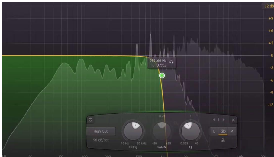
Figura 113. Low pass cerca de los 500 Hz. No se entiende ni la voz ni las guitarras.
