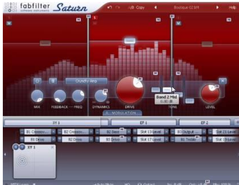
Figura 56. Dando forma a la distorsión en paralelo del bajo escuchando solo los medios. Como se puede ver, el resto de las bandas de frecuencias están en mute . Tomado de Mixing Bass junto a Acle Kahney.
