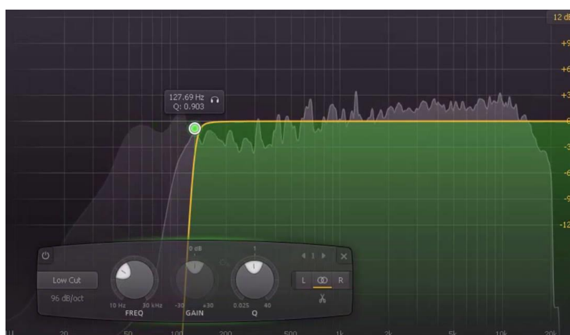
Figura 103. High pass cerca de los 125 Hz. Se siente como desaparecen los graves.
