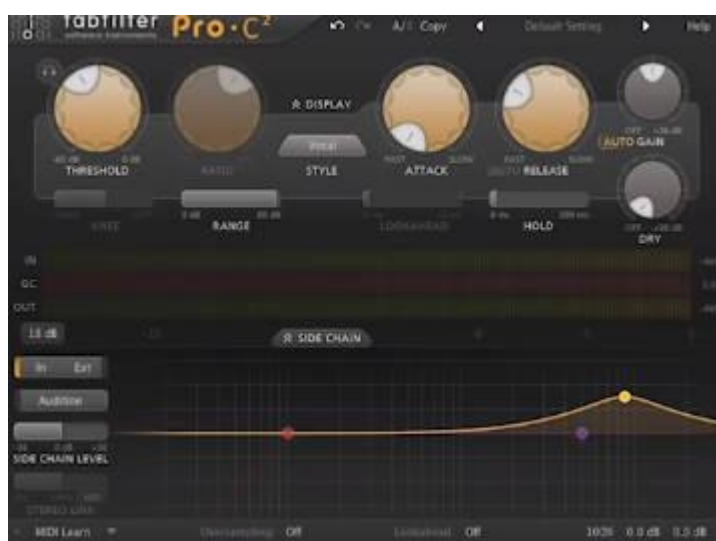
Figura 93. Ejemplo de truco de de essing con compresor utilizando el ecualizador por sidechain de Pro-C2 , aplicando un boost de 15 dB en los 9000 Hz. Tomado de Adam “Nolly” Getgood Mixing Masterclass en Youtube .
