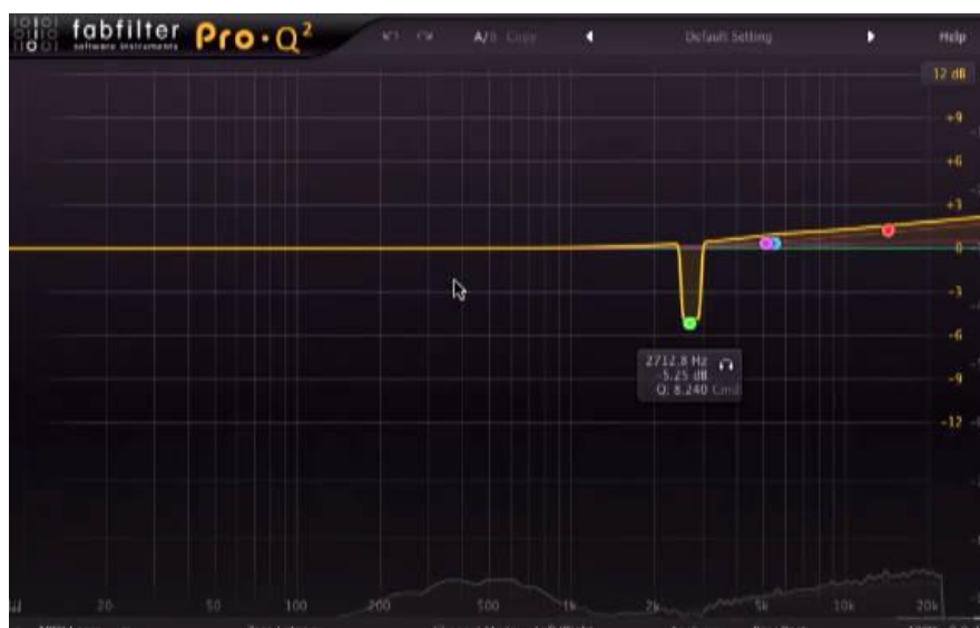
Figura 42. Forma cuadrada de banda para remover frecuencias indeseadas. Tomado de Nail The Mix junto a Taylor Larson y Jason Richardson.
