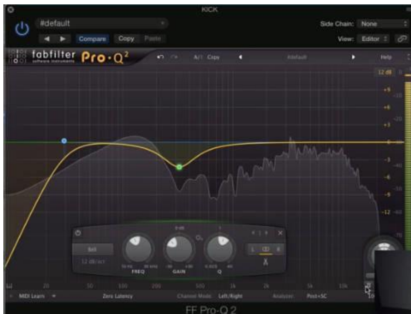
Figura 36. Ecualización de bombo de batería basándose en el análisis de espectrómetro de FF Pro-Q2 para encontrar las frecuencias más importantes y atenuar las frecuencias medias que están alrededor. Con esto se exaltan las calidades del bombo y su sonido grave. Se puede observar cómo las frecuencias de fundamental y los medios agudos son más prominentes que el resto de las frecuencias. Tomado de Nail the Mix junto a Adam “Nolly” Getgood de Periphery .
