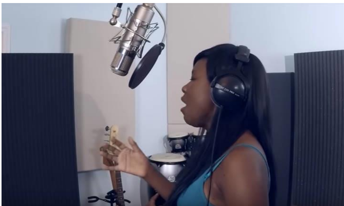
Figura 25. Cantante grabando con un micrófono U47 FET fuera de axis, apuntando hacia afuera de la intérprete. Tomado de Three recording techniques for vocals del canal de Youtube MusicTechHelpGuy.
