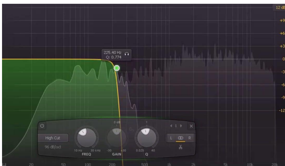
Figura 120. Low pass en medios graves. En los 600 Hz los graves se toman la mezcla casi completamente, y en los 200 la voz desaparece, aunque a veces se perciben algunas consonantes "deslizables" como la "w". Pero básicamente ya solo se escuchan graves profundos.
