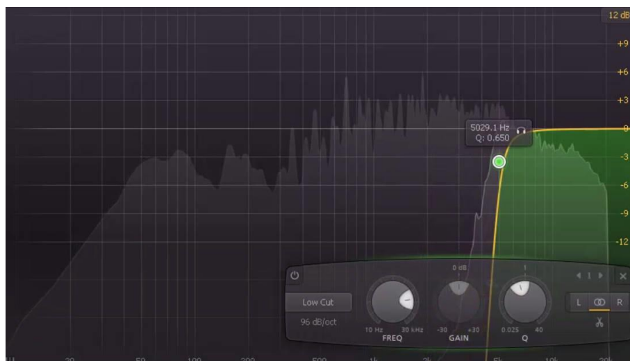
Figura 111. High pass en los 5000 Hz. Solo se entienden las resonancias agudas de los platos.
