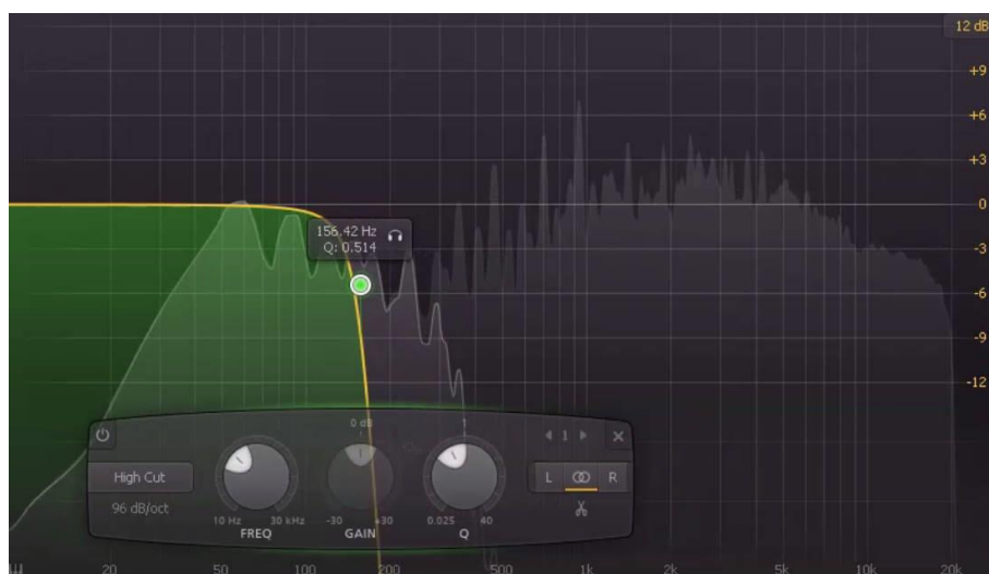
Figura 114. Low pass en los medios graves. Solo se sienten los graves de los instrumentos, principalmente el bajo y queda un poco del ataque de la caja en los graves, pero se mezcla mucho con las resonancias graves.
