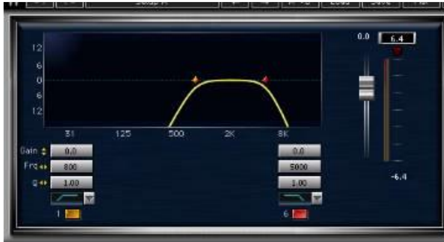
Figura 68. Filtrado aplicado a una pista de bajo agudo. Se puede cortar los agudos con un low pass como en este ejemplo, pero no es necesario. Tomado de Modern Metal Bass Tone Tutorial de Chernobyl Studio en Youtube.
