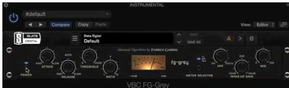
Figura 29. Compresor FG-Grey de la colección de Virtual Buss Compressors de Slate Digital. Como se puede observar el ataque está muy rápido y el release lo más rápido, con una ratio de 4:1. El control de high pass filter (HPF) se usa para evitar que el compresor actúe demasiado con los graves del bombo, sólo el compresor es afectado por el HPF, no la señal original. Tomado de Nail the Mix junto a Adam “Nolly” Getgood de Periphery .
