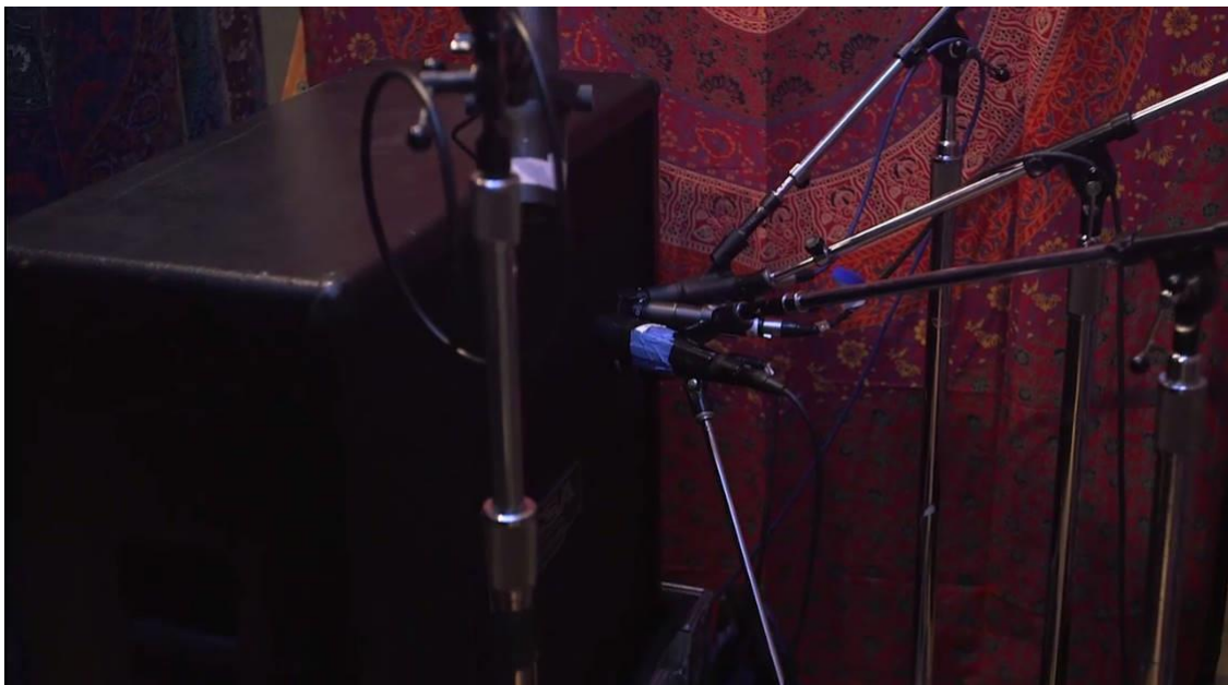
Figura 13. Técnica Fredman con un micrófono extra. Tomado de Recording Metal with Eyal Levi.
