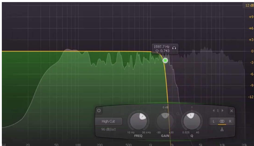
Figura 119. Low pass en medios. Mientras que en las otras canciones al llegar a los 10000 Hz se perdía mucho de los platos, en esta canción hay una especie de china que inclusive en los 8000 Hz sigue manteniendo ataque, pero ya en los 7000 pierde el detalle del ataque, pero al ser tan repetitivo y marcar las negras, es algo que destaca. En los 3000 Hz aproximadamente desaparecen los platos.
