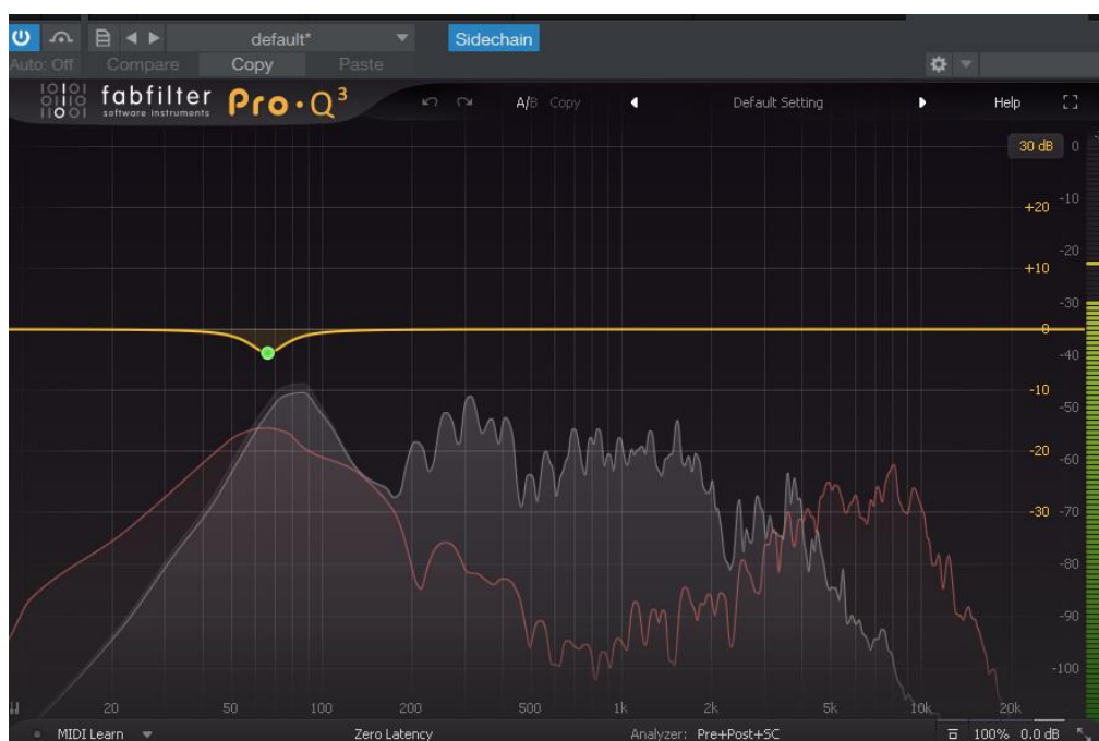
Figura 150. Ecualización con sidechain utilizada en la mezcla del tema Blindfolded . En blanco se puede observar el análisis de espectro del bajo y en rojo el del bombo. Se atenuó levemente en el bajo para crear más separación entre estos dos instrumentos. Con este análisis se procedió a atenuar en el bombo justo después de los 100 Hz para que el bajo ocupe ese espacio de manera más notoria.
