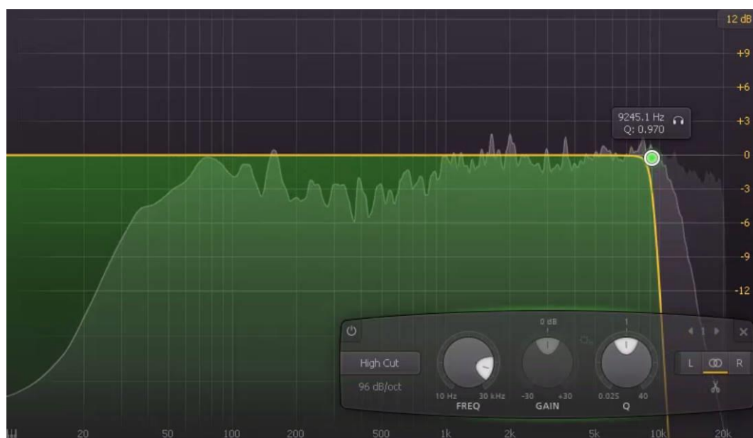
Figura 118. Low pass en agudos. El brillo de la mezcla se pierde al colocar un filtro low pass entre los 8 y 9 kHz y suena opaca. Los platos pierden su sizzle .
