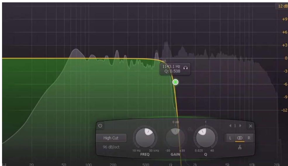
Figura 107. Low pass por debajo de los 5000 Hz. Los instrumentos todavía retienen cuerpo, acercándose a los 3000 Hz se escuchan las frecuencias graves de los instrumentos y los medios.
