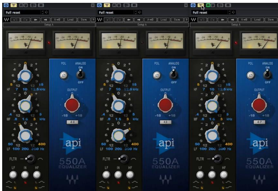
Figura 88. Ejemplo de ecualización de voces para distinguirlas unas de otras. En este ejemplo a la voz principal se le ha aplicado el ecualizador del lado derecho aplicando boosts en 400 y 3000 Hz. Mientras que a las voces secundarias que doblan a la voz principal se les ha aplicado el mismo boost en los 400 Hz, pero se ha atenuado frecuencias en los medios y medios agudos. Mientras que a las voces secundarias que hacen armonías se les ha aplicado el ecualizador de la izquierda, atenuando los 400 Hz que se acentuaron en los otros grupos de voces, y acentuando los mismo 3000 Hz de la voz principal. Tomado de Deconstructing A Heavy Rock Mix de Groove3.
