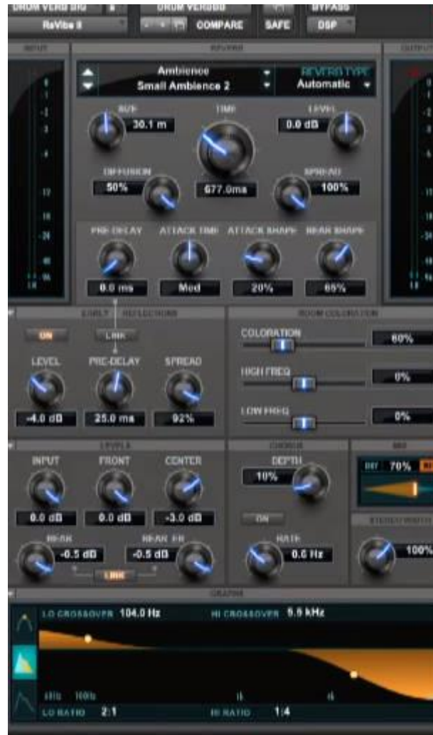
Figura 35. Preset de reverb de Taylor Larson. Va en las dos cajas, la de micrófono arriba y la de abajo. Le aporta más cuerpo a una caja. Tomado de Nail The Mix junto a Taylor Larson y Jason Richardson.
