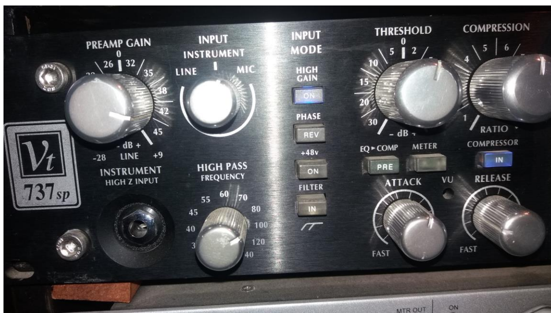
Figura 140. Settings de compresión dentro del channel strip ataque en el medio, y release rápido. Con ratio de 6:1.
