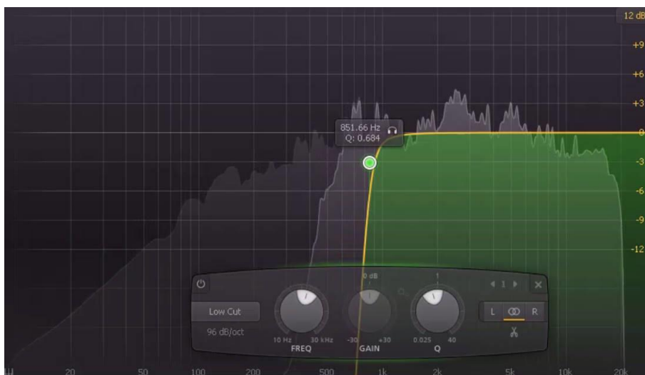
Figura 110. High pass en los medios. Se escuchan las guitarras y la voz claramente, pero sin los graves, el cuerpo y detalles están presente, en los 1000 Hz toda la batería va perdiendo ataque a excepción de los platos. En los 3000 prácticamente solo se escuchan los agudos de las guitarras y platos y lo que queda de ataque de la caja, que desaparece pasados los 6000 Hz.
