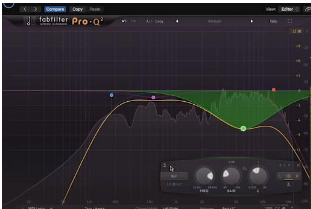
Figura 52. Ecualización aplicada a overheads . Tomado de Adam “Nolly” Getgood Mixing Masterclass en Youtube.
