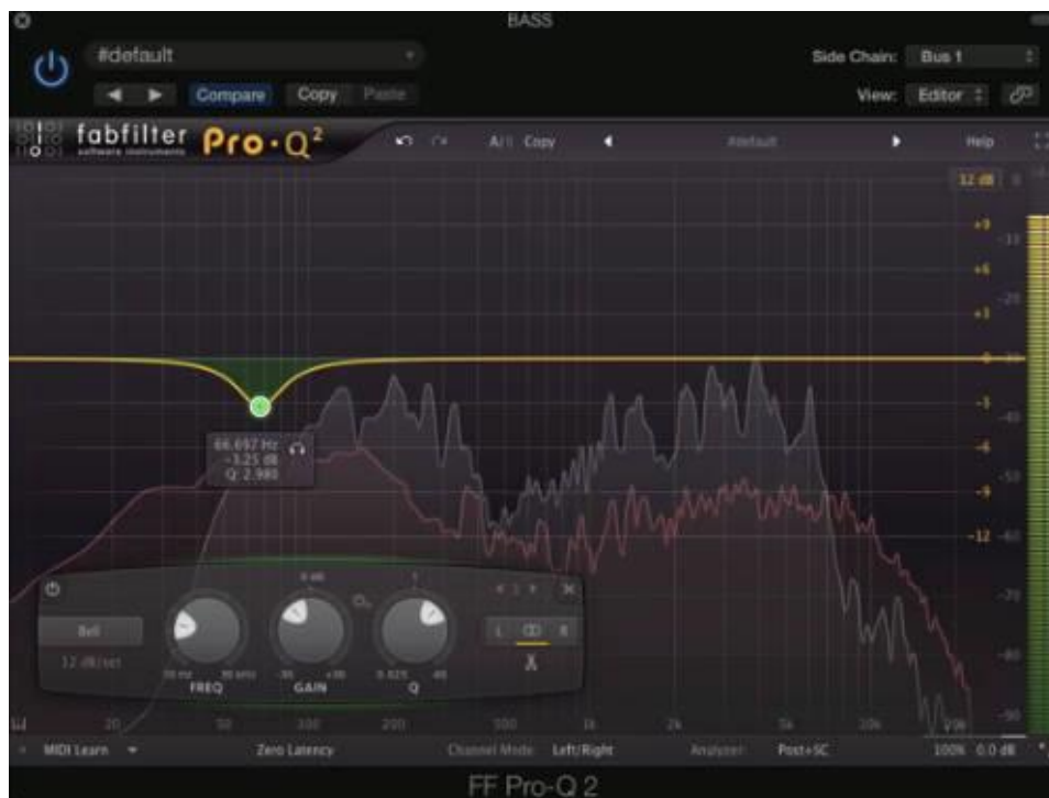
Figura 63. Ecuador Pro-Q analizando frecuencias de bajo y bombo al mismo tiempo, y atenuando frecuencias del bajo en la fundamental del bombo de batería. Tomado de Nail the Mix junto a Adam “Nolly” Getgood de Periphery .
