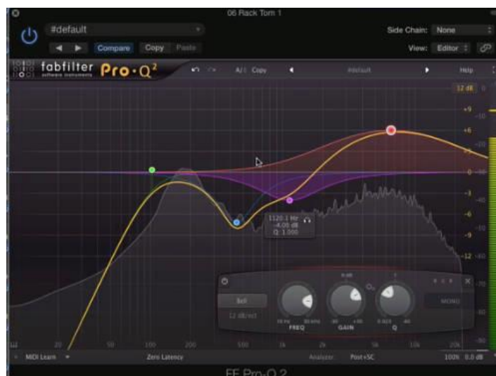
Figura 43. Aplicación de ecualización para aislar la fundamental y dar más presencia y ataque a un tom . En este caso particular también se atenuó frecuencias en los medios para eliminar cualidades “cartonosas” entre 1 kHz-8kHz que es algo que se puede probar en los toms y bombo, para darles mayor profundidad. Como se puede observar se agregó un boost en los agudos que da más aire y presencia. Tomado de Nail the Mix junto a Adam “Nolly” Get de Periphery .
