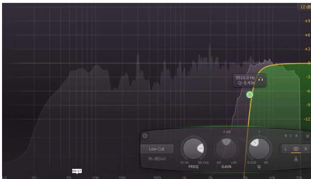
Figura 117. High pass en agudos. En los 11 kHz se escucha más las vibraciones agudas y sibilancia de los platos, pero al bajar de nuevo a los 6000 el sonido de los agudos de los platos se suaviza. Los platos no son tan sibilantes como en las otras canciones.
