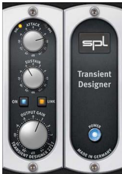
Figura 33. Modulador de transient de UAD con controles de sustain y ataque. Tomado de SPL Transient Designer de uaudio.com.
