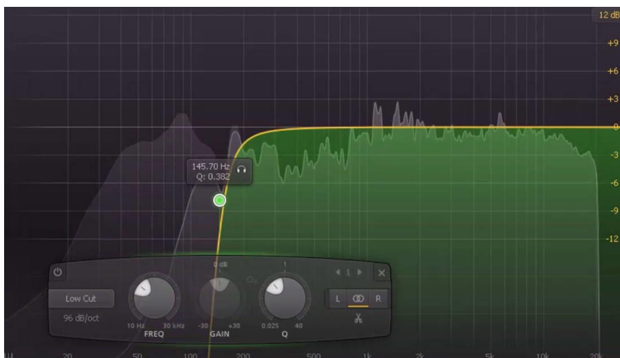
Figura 115. High pass cerca de los 145 Hz. Los bajos profundos se pierden, en los 300Hz desaparecen los graves, ya no se sienten.
