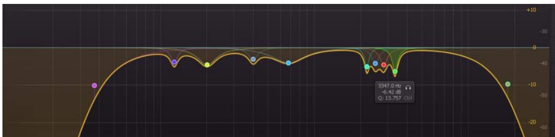
Figura 73. Ejemplo de ecualización de guitarras con frecuencias abrasivas y resonancia molesta en los medios graves y medios. Tomado de Processing and Mixing Guitars de Aclé Kahney.
