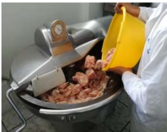
Figura 4. Adición de pechugas de pollo en el Cutter
