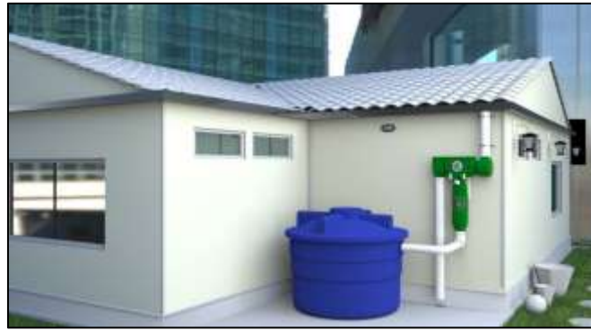
Figura 13. Estructura de captación pluvial Adaptado de: Naranjo (2017)
