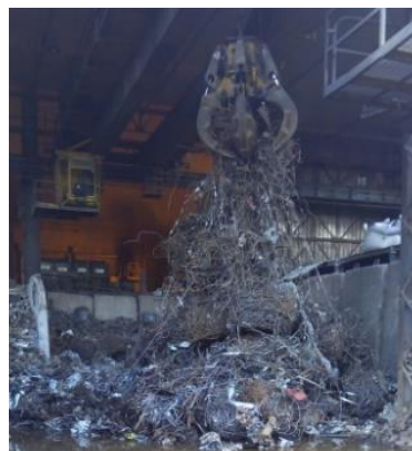
Figura 54. Material listo para el horno de pacas enredadas entre sí. Tomado de (Departamento de Metálicos, 2018).
