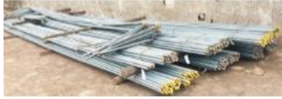
Figura 92. Varillas con estaño superior a especificación. Tomado de (Calidad Laminación, 2018).
