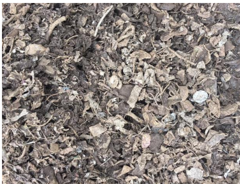
Figura 43. Material Shredder Nacional con exceso de tierra.
