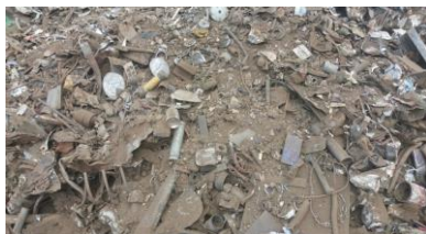
Figura 46. Material HMS con exceso de tierra. Tomado de (Departamento de Metálicos, 2018).
