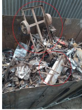
Figura 49. Elementos no cumplen especificación en dimensiones de HMS. Tomado de (Departamento de Metálicos, 2018).
