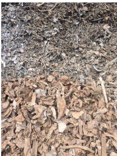
Figura 42. Producto terminado con baja densidad (parte superior). Con densidad que cumple especificación (parte inferior).
