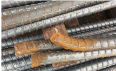
Figura 93. Producto terminado con roturas por fragilidad del acero. Tomado de (Calidad Laminación, 2018).
