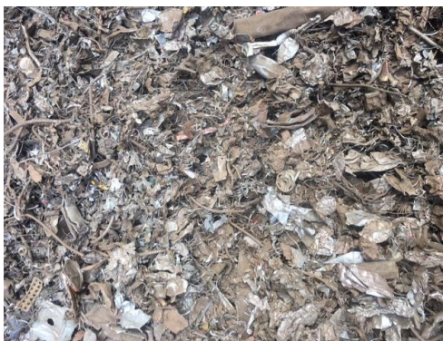
Figura 44. Material Shredder Nacional con densidad de 0,78 \text{ Tm/m}^3 . Tomado de (Departamento de Metálicos, 2018).
