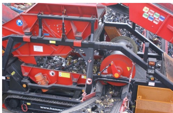
Figura 27. Funcionamiento separadora Hammel MMS 150 DK.
