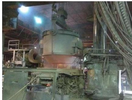
Figura 60. Carga de Cestas con chatarra al horno eléctrico (Power Off). Tomado de (Carga de Cestas, 2017).
