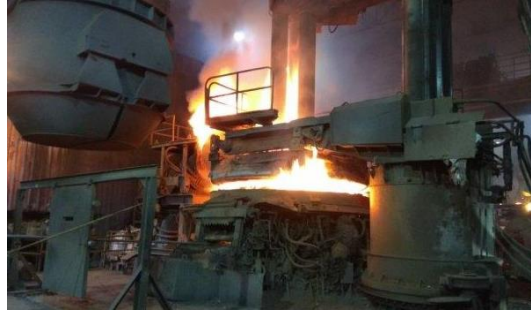
Figura 58. Fundición de chatarra en horno de arco eléctrico (Power On).
