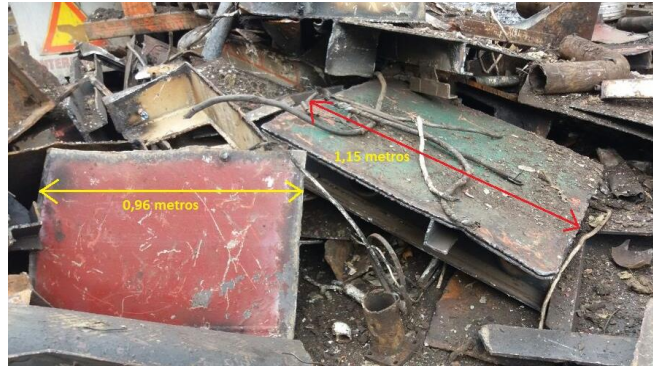
Figura 57. Elementos que superan la especificación en dimensiones. Tomado de (Departamento de Metálicos, 2018).
