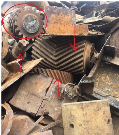
Figura 85. Engranajes mezclados en producto P&S Especial. Tomado de (Departamento de Metálicos, 2018).
