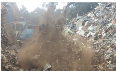
Figura 47. Descarga de material HMS en el patio de procesamiento para ser reprocesado por contener exceso de tierra y no cumplir especificación. Tomado de (Departamento de Metálicos, 2018).
