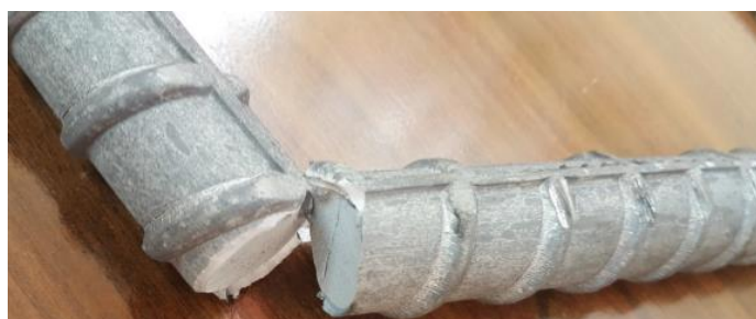
Figura 90. Rotura por fragilidad del acero.
