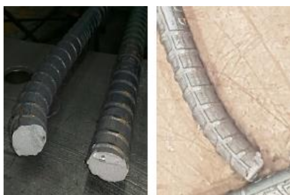
Figura 91. Producto no conforme.
