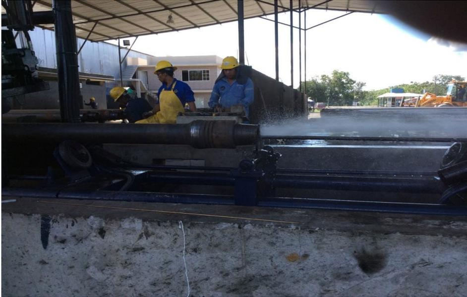
*Figura 2.* Área de lavado de tuberías - operador de la cepilladora - manipulación de controles
