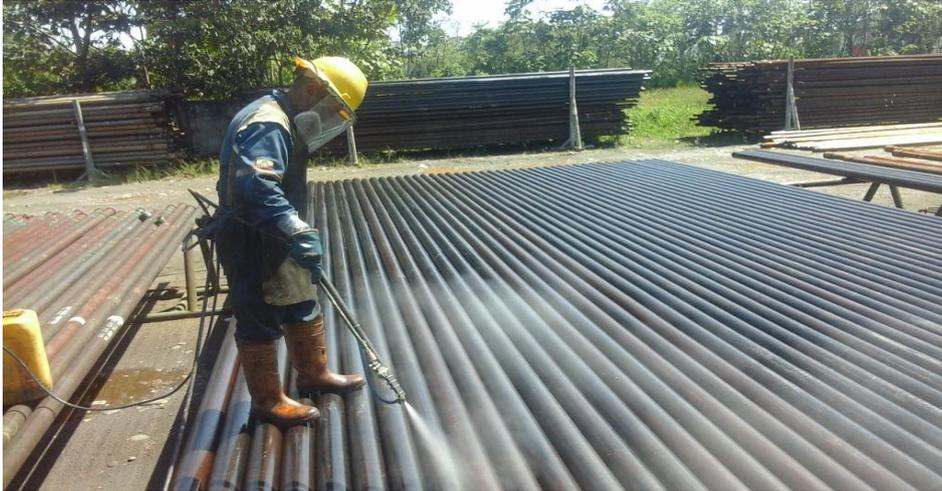
*Figura 12.* Área de aplicación de protección a las tuberías - ayudante de patio - aplicando protección externa
