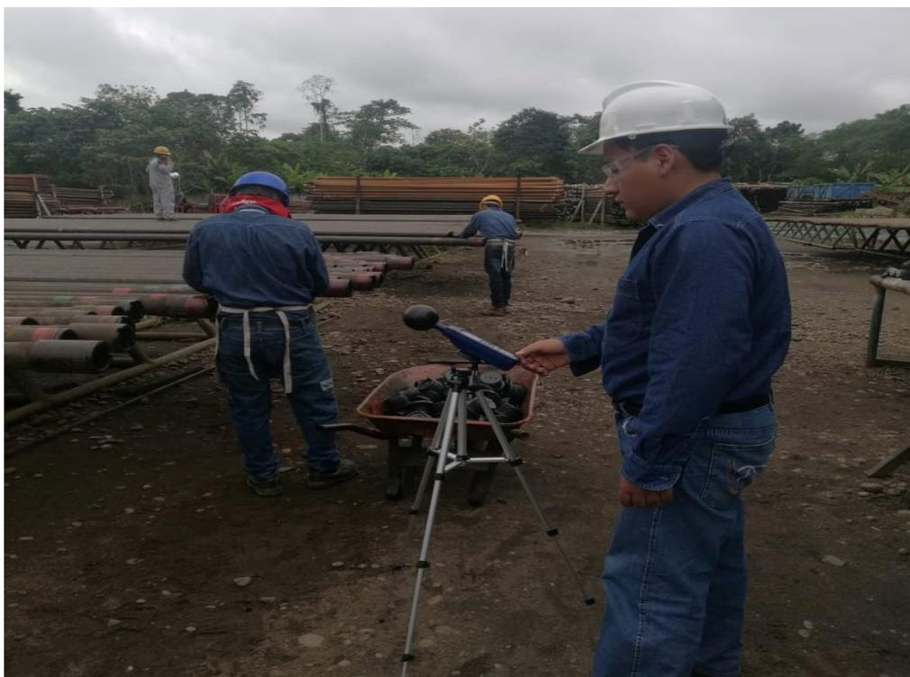
*Figura 32.* Medición del ambiente térmico - Área de inspección de tuberías
