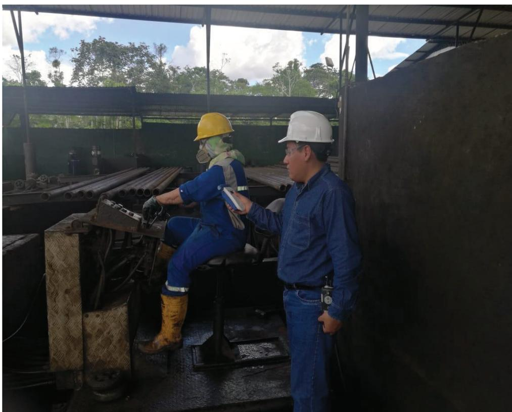
*Figura 28.* Medición con el monitor de gases y vapores - Área de lavado de tuberías
