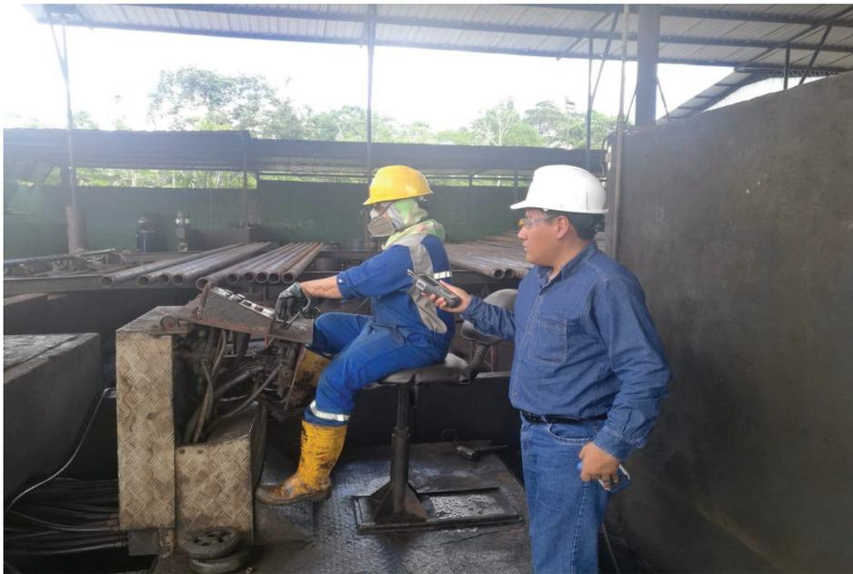
*Figura 25.* Medición con el monitor de material particulado en la cepilladora
