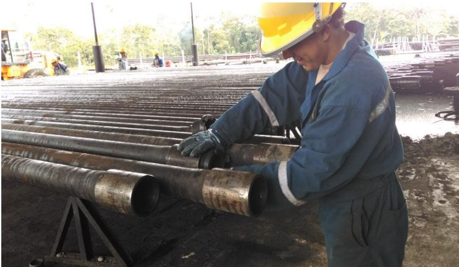
*Figura 3.* Área de lavado de tuberías - ayudante de patio - lavando conexiones
