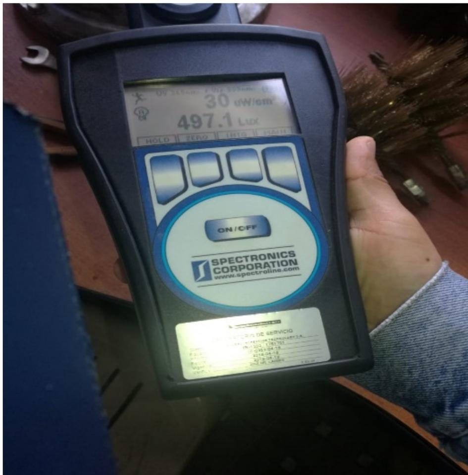
*Figura 23.* Medición de iluminación utilizando el luxómetro
