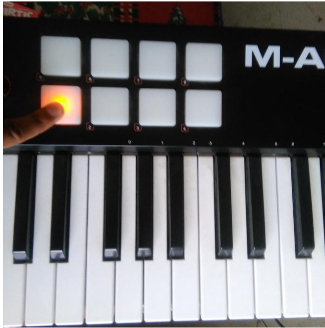
Figura 17. Pads incorporados en el controlador MIDI.
