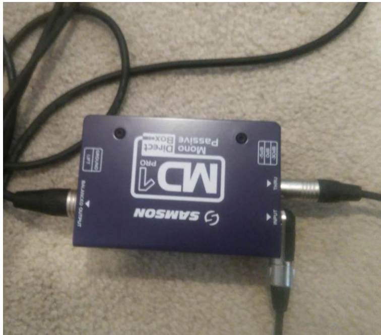
Figura 50. Caja directa Samson CM1 para adaptar la impedancia de la guitarra.
