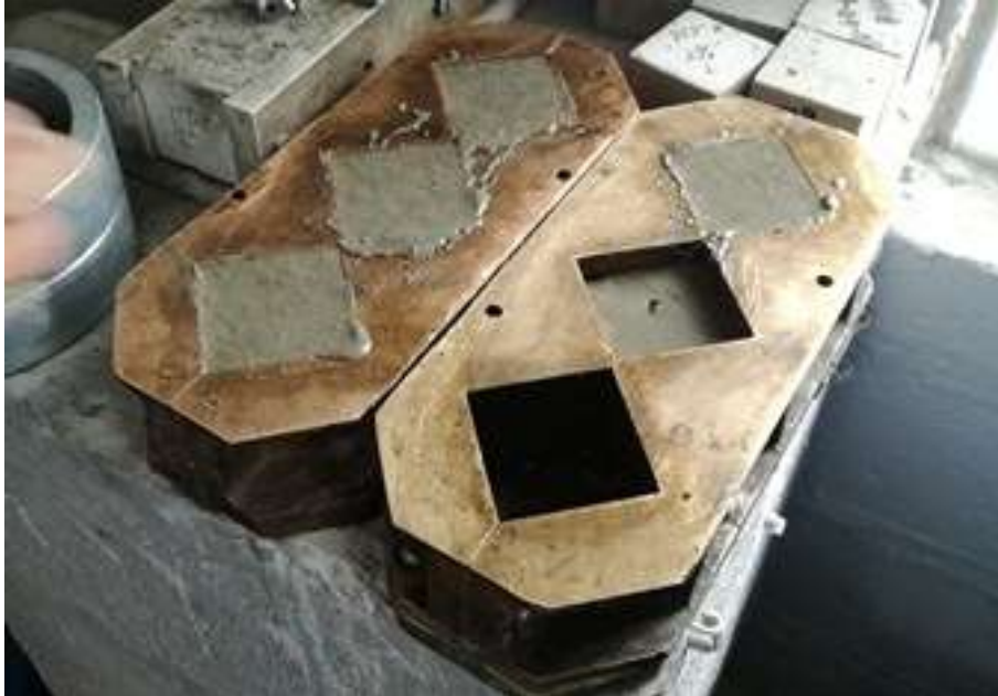
Figura 50 Mezcla ya colocada en el molde
