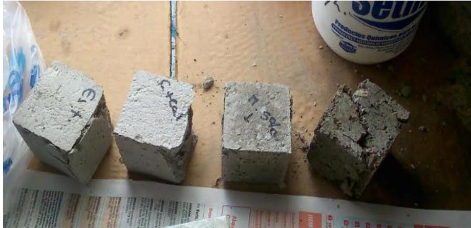
Figura 55. Cubos de mortero para ensayos.
