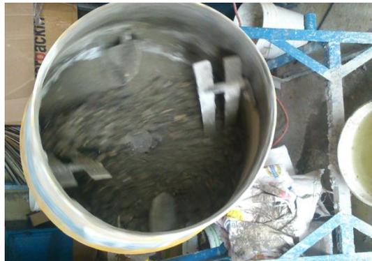
Figura 43. Mezcla de los componentes del ladrillo en la concretara.
