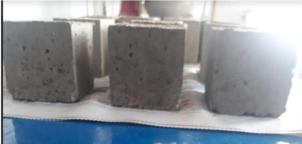
Figura 53. Cubos de mortero para ser ensayados.
