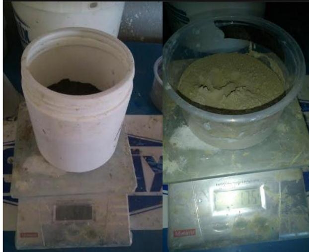
Figura 49. Pesaje de los componentes cemento, arena, cal, maní y agua
