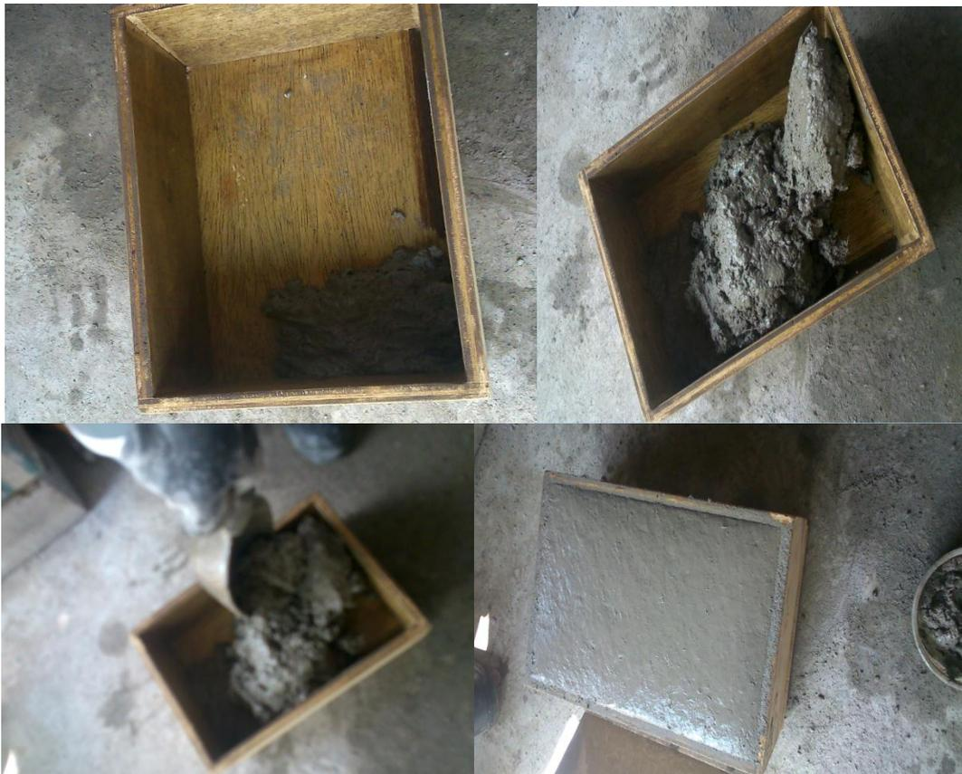
Figura 45. Colocación de la mezcla en el molde.
