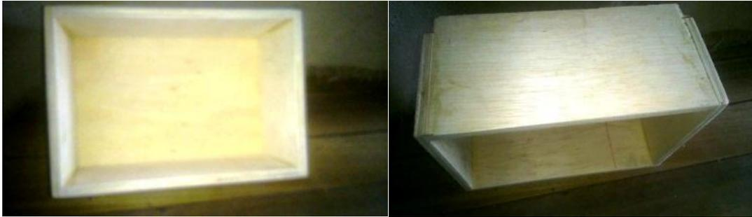
Figura 44. Molde para modelado del ladrillo.
