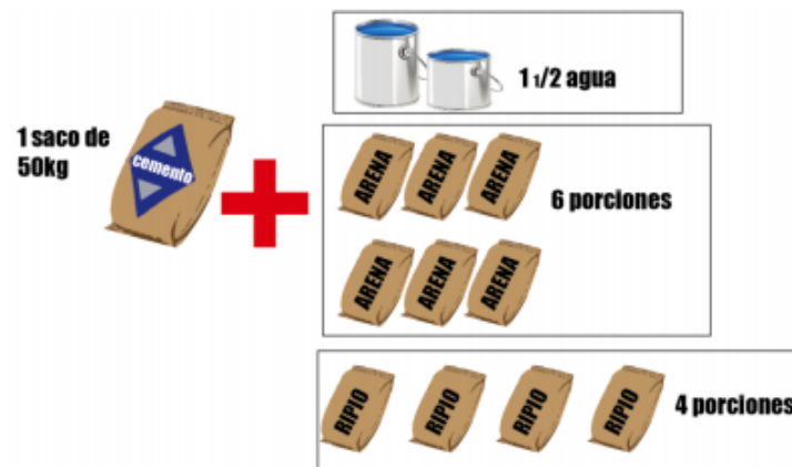
Figura 63. Dosificación especificada para el dado de hormigón.
