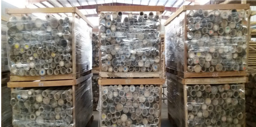
Figura 20. Almacenamiento horizontal de la caña guadua Tomado de: (Guaduabambucolombia, 2015)
