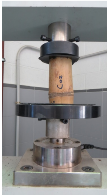
Figura 22. Ensayo de compresión de una caña guadua
