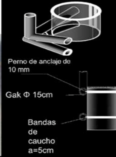
Paso 4: Colocación de la envolvente sobre la estructura.
