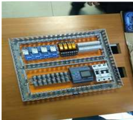
Figura 46 Colocación de Canaleta ranurada
