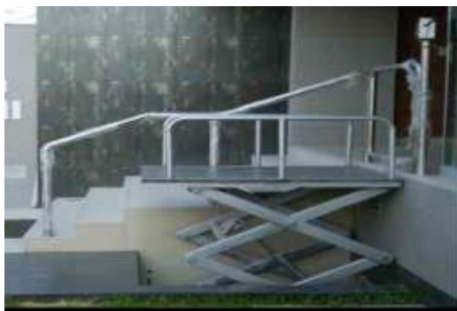
Figura 7 Plataforma hidráulica de tipo tijera Tomado de: ELEVAL, (2016)
