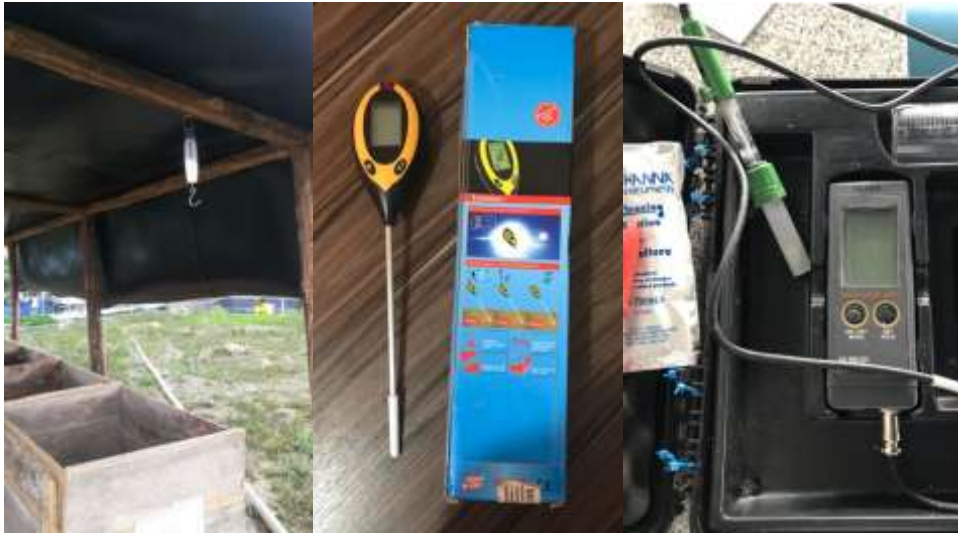
Figura 12. Instrumentos utilizados en la medición de peso, pH, luz, temperatura y humedad.
