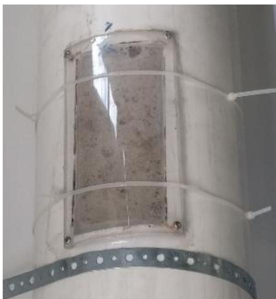
Generación de espuma antes de colocar el antiespumante en base silicona.
