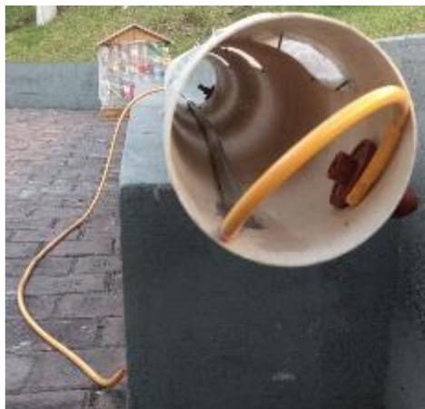
Interior de la columna, parte superior por donde ingresaba la fuente aire para el tratamiento de oxidación.
