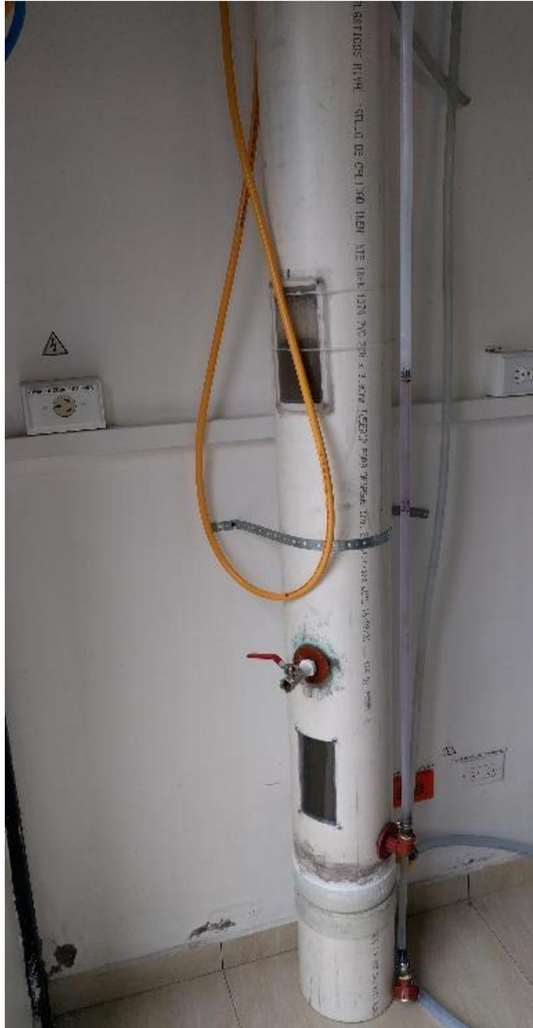
Figura 5. Torre utilizada en el tratamiento de oxidación de sulfuros.
