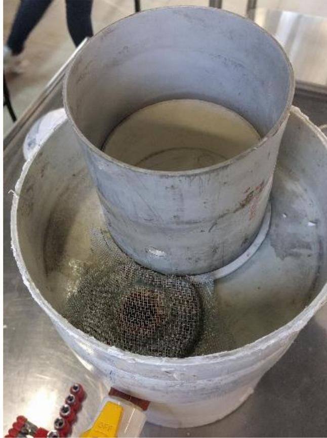
Difusor que colocado en el interior de la columna para el tratamiento de oxidación.
