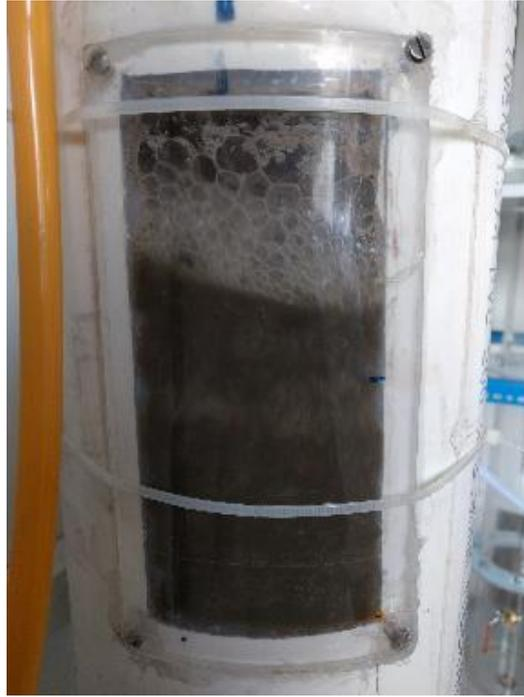
Baja generación de espuma luego de colocar antiespumante.
